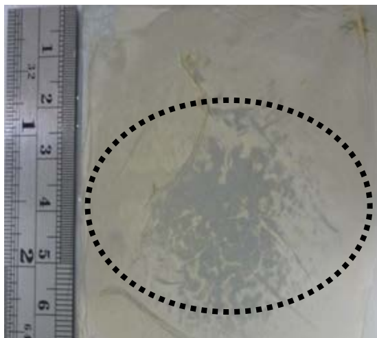
ภาพที่ 4.11 ลักษณะแผ่นเส้นใยพอลิอิมิดิกแอซิดที่ถูกอบพลาสติกมาโดยใช้กำลังวัตต์ 75 W, ความดันคงที่ที่ 0.5 torr, และเวลาที่ใช้ในการอบพลาสติกมา 300 sec
