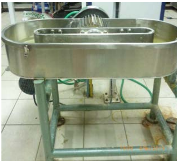
ง. 2 เครื่องบดเยื่อ (Valley beater รุ่น UEC-2018A Universal engineering corporation/ India)
