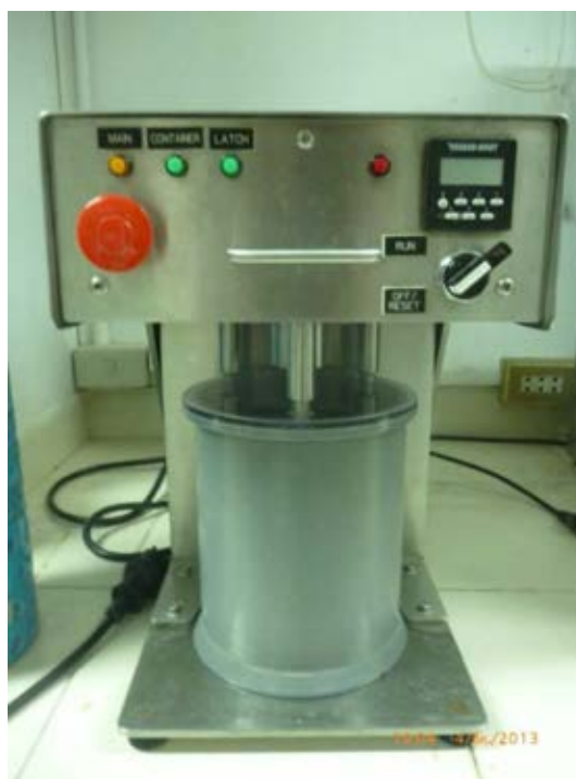
ง.4 เครื่องตีกระจายเยื่อ (Disintegrator) รุ่น T-292 Adirondack Machine Corporation/ USA)
