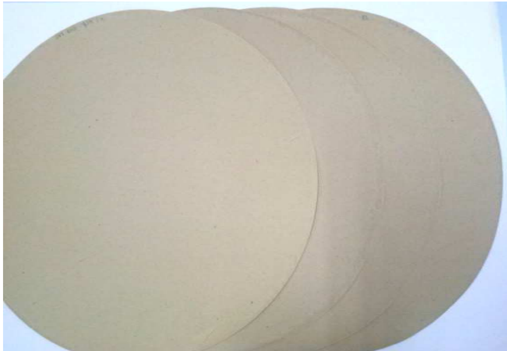
รูปที่ 4.3 กระดาษที่ได้จากการผลิตเยื่อ ที่แอกที่ฟัลคาไลน์ 20%, 23%, 25% และ 28% จากซ้ายไปขวาตามลำดับ
