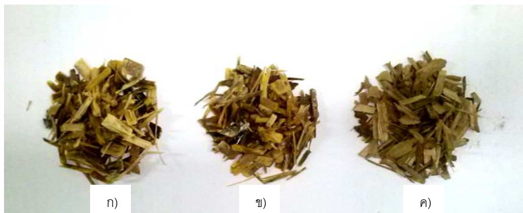
รูปที่ 4.9 ชี้น้ไม้จากชุดการทดลอง ก) ผ่านการปรับสภาพด้วยราที่คัดเลือก ข) ผ่านการปรับสภาพด้วยราสายพันธุ์อ้างอิง ค) ไม่ปรับสภาพด้วยรา
