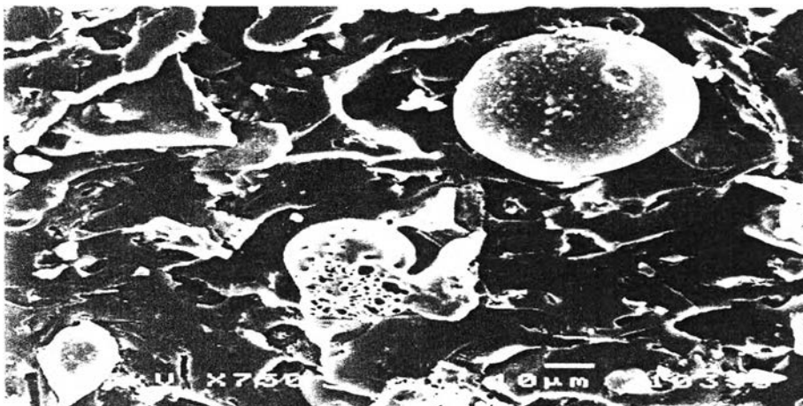
รูปที่ ๑.9 สัณฐานวิทยาของวัสดุเชิงประกอบระหว่างพอลิเอสเตอร์เรซิน ชนิดไม่อิ่มตัวและแก้วแกลบ (100 : 50 phr)
