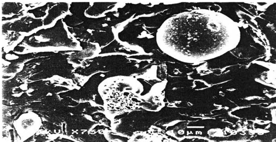
รูปที่ ๑.10 สัณฐานวิทยาของวัสดุเชิงประกอบระหว่างพอลิเอสเตอร์เรซิน ชนิดไม่อิ่มตัว/ยางธรรมชาติ/เถ้าแกลบ (100 : 5 : 30 phr)
