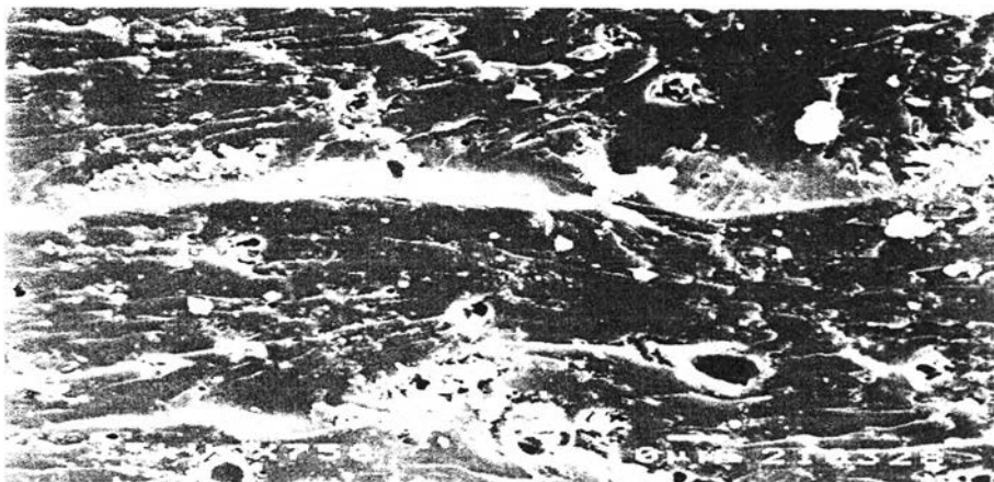
รูปที่ ๑.4 สัณฐานวิทยาของพอลิเมอร์ผสมระหว่างพอลิเอสเตอร์เรซิน ชนิดไม่อิ่มตัวและยางธรรมชาติกราฟต์สไตรีน (100 : 5 phr)
