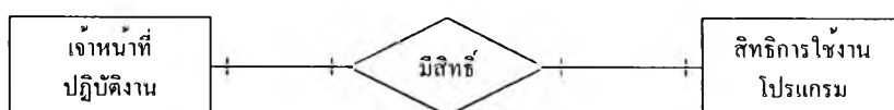
รูปที่ 4.25 แผนภาพแสดงความสัมพันธ์ของข้อมูลในกลุ่มของสิทธิการใช้งานของระบบสนับสนุนการตัดสินใจจัดสรรน้ำในโครงการชลประทาน
