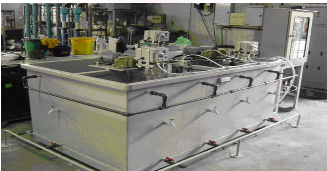
รูปที่ 3.1 ระบบบำบัดน้ำเสียแบบที่ใช้ไมโครฟิลเตรชันเมมเบรนในถังปฏิกรณ์ชีวภาพที่ใช้ในการทดลอง
