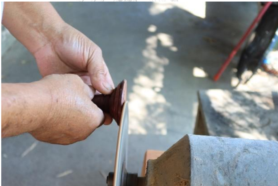
ภาพที่ 148 การเจียรฐานเสาบัณเฑาะว์ ที่มาภาพ : ผู้วิจัยบันทึกภาพเมื่อวันที่ 12 พฤษภาคม 2563
