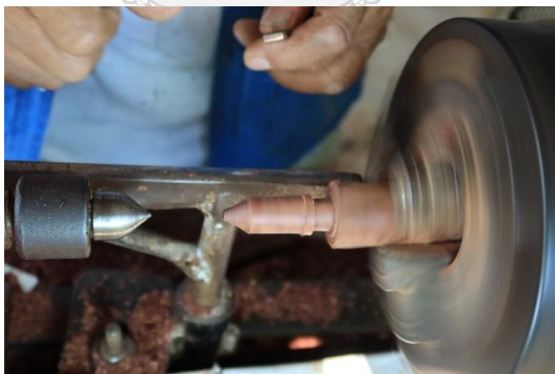
ภาพที่ 168 การใช้มีดแบนกลึงให้เป็นรูปคล้ายกับแท่งดินสอด ที่มาภาพ : ผู้วิจัยบันทึกภาพเมื่อวันที่ 13 พฤษภาคม 2563
