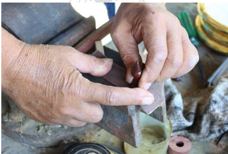
ภาพที่ 176 การใช้กระดาษทรายเบอร์ 120 ฝนฐานให้เรียบ ที่มาภาพ : ผู้วิจัยบันทึกภาพเมื่อวันที่ 13 พฤษภาคม 2563
