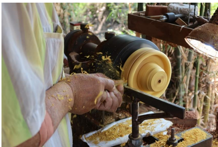
ภาพที่ 103 การขีดเส้นเพื่อกลึงขอบออกจากเครื่องกลึง ที่มาภาพ : ผู้วิจัยบันทึกภาพเมื่อวันที่ 10 พฤษภาคม 2563
