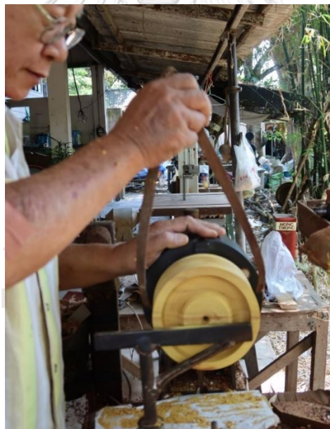
ภาพที่ 100 การใช้เขาควยัดเส้นรอบวงของไม้ ที่มาภาพ : ผู้วิจัยบันทึกภาพเมื่อวันที่ 10 พฤษภาคม 2563
