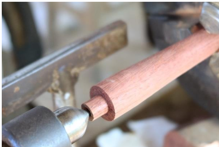
ภาพที่ 129 การเจาะรูเสาบัณเฑาะว์ ที่มาภาพ : ผู้วิจัยบันทึกภาพเมื่อวันที่ 12 พฤษภาคม 2563
