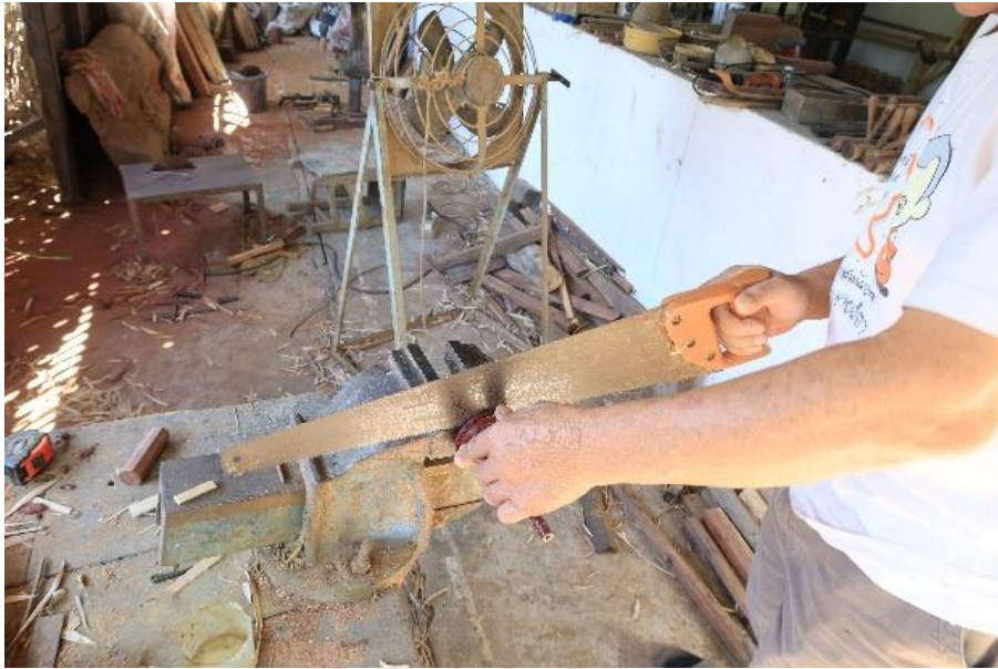
ภาพที่ 147 การเลื่อยเสาบัณเฑาะว์ ที่มาภาพ : ผู้วิจัยบันทึกภาพเมื่อวันที่ 12 พฤษภาคม 2563
