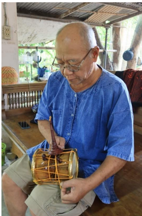
ภาพที่ 205 การผูกเชือกเข้ากับเสา ที่มาภาพ : ผู้วิจัยบันทึกภาพเมื่อวันที่ 16 พฤษภาคม 2563
