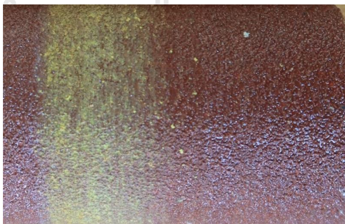
ภาพที่ 72 กระดาษทรายเบอร์ 120 ใช้ขัดเก็บรายละเอียดชิ้นต้น
