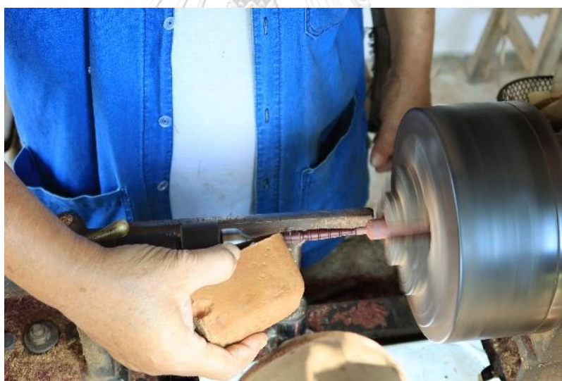
ภาพที่ 160 การลงไขปลาวาฬที่ชิ้นชะเนาะ ที่มาภาพ : ผู้วิจัยบันทึกภาพเมื่อวันที่ 13 พฤษภาคม 2563
