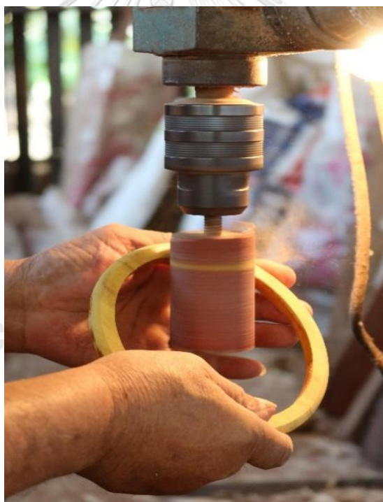
ภาพที่ 106 การขัดขอบไม้ ที่มาภาพ : ผู้วิจัยบันทึกภาพเมื่อวันที่ 10 พฤษภาคม 2563
