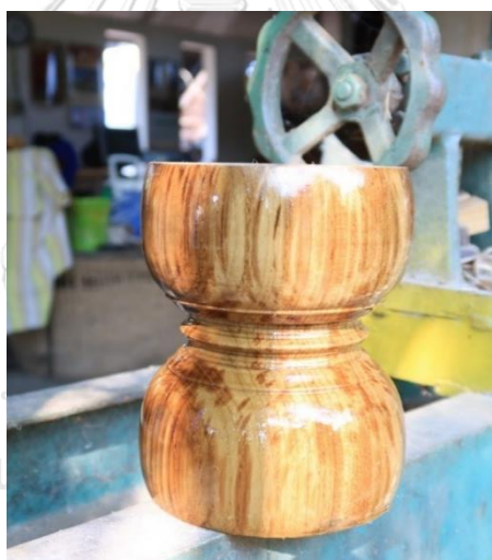
ภาพที่ 125 การพ่นแลคเกอร์ที่หุ่นบ้นเตาะว ที่มาภาพ : ผู้วิจัยบันทึกภาพเมื่อวันที่ 11 พฤษภาคม 2563 เคลือบแลคเกอร์เพื่อรักษาเนื้อไม้และความสวยงาม พ่นแลคเกอร์ทิ้งไว้ประมาณ 3 - 4 ครั้ง ทิ้งไว้ 1 คืน
