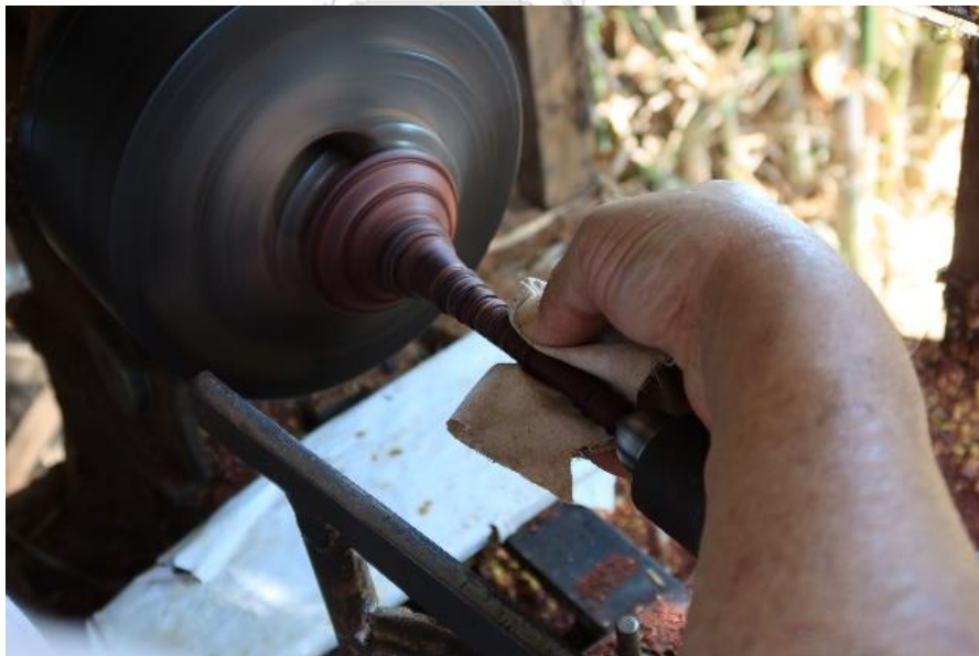
ภาพที่ 144 การใช้ผ้าลูบไขปลาวาฬให้ทั่วเสائبัณเฑาะว์ ที่มาภาพ : ผู้วิจัยบันทึกภาพเมื่อวันที่ 12 พฤษภาคม 2563
