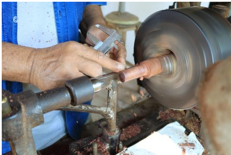
ภาพที่ 167 การใช้เวอร์เนียร์คาลิปเปอร์วัดขนาดหัวขุน ที่มาภาพ : ผู้วิจัยบันทึกภาพเมื่อวันที่ 13 พฤษภาคม 2563
