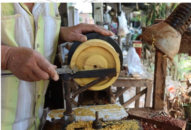
ภาพที่ 97 การใช้มีดเล็บบกลึงขอบบ้นเตาะว้ ที่มาภาพ : ผู้วิจัยบันทึกภาพเมื่อวันที่ 10 พฤษภาคม 2563
