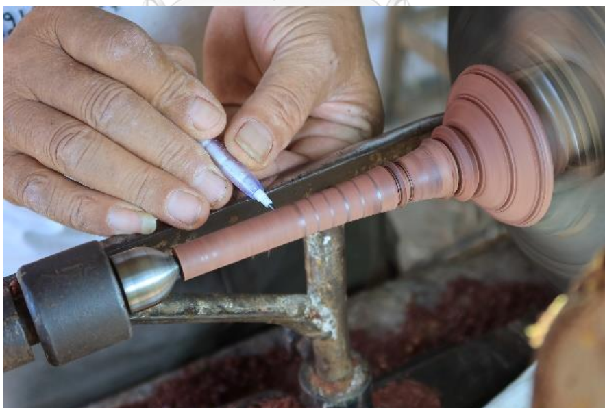
ภาพที่ 138 การขีดเส้นทำบัวกลุ่ม
