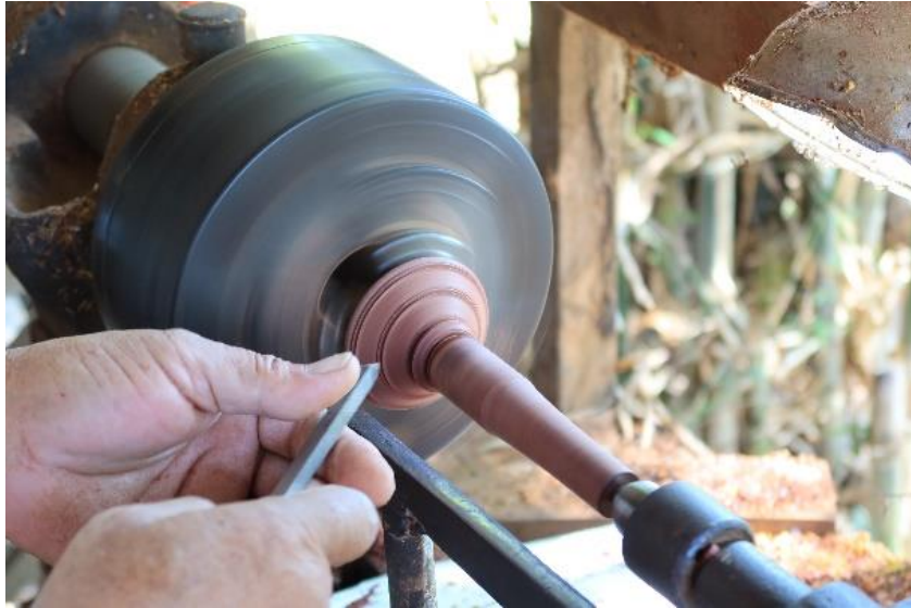
ภาพที่ 133 การทำบัวกลาที่ฐานเสา ที่มาภาพ : ผู้วิจัยบันทึกภาพเมื่อวันที่ 12 พฤษภาคม 2563
