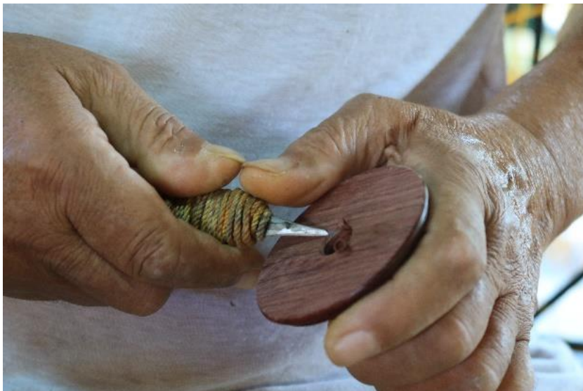
ภาพที่ 193 การลอบคมรูฐานของเสาบัณเฑาะว์
