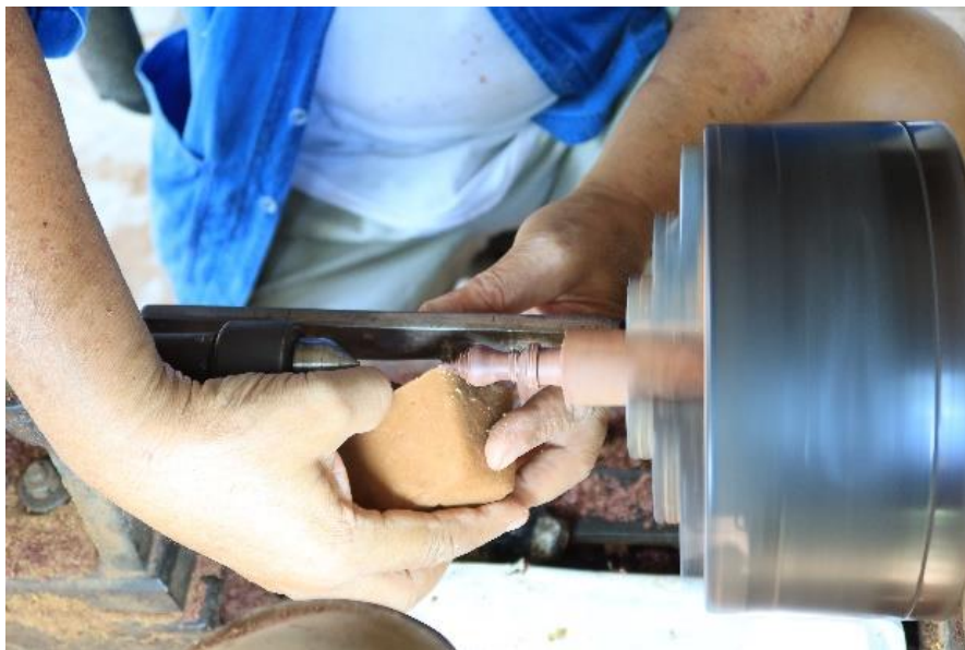
ภาพที่ 173 การใช้ไขปลาวาฬขัดมัน ที่มาภาพ : ผู้วิจัยบันทึกภาพเมื่อวันที่ 13 พฤษภาคม 2563
