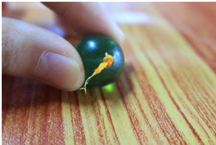
ภาพที่ 203 ลูกตุ้มที่ผูกเชือกและหยอดกาวเรียบร้อย ที่มาภาพ : ผู้วิจัยบันทึกภาพเมื่อวันที่ 16 พฤษภาคม 2563
