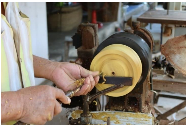
ภาพที่ 97 การใช้มีดเล็บบกลึงขอบบ้นเตาะว้ ที่มาภาพ : ผู้วิจัยบันทึกภาพเมื่อวันที่ 10 พฤษภาคม 2563
