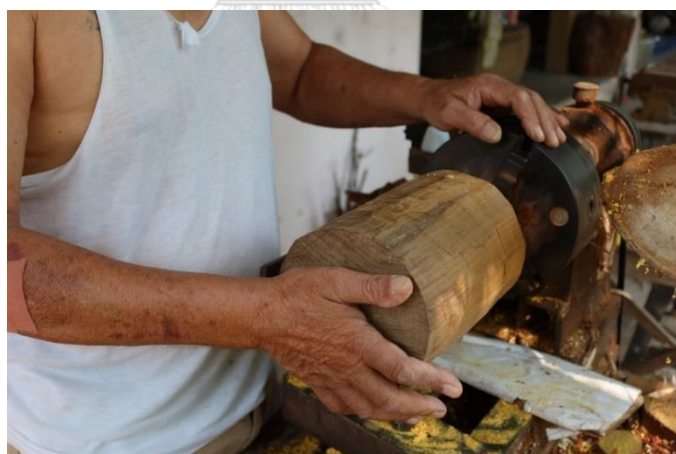
ภาพที่ 112 นำไม้สักเข้าเครื่องกลึง
