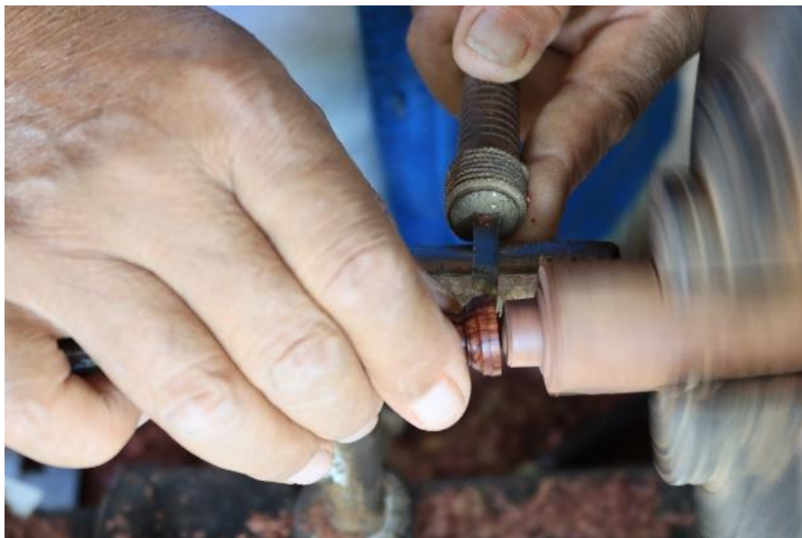
ภาพที่ 175 การใช้มีดตัดฐานหัวขุ่นออกจากแกนไม้ ที่มาภาพ : ผู้วิจัยบันทึกภาพเมื่อวันที่ 13 พฤษภาคม 2563
