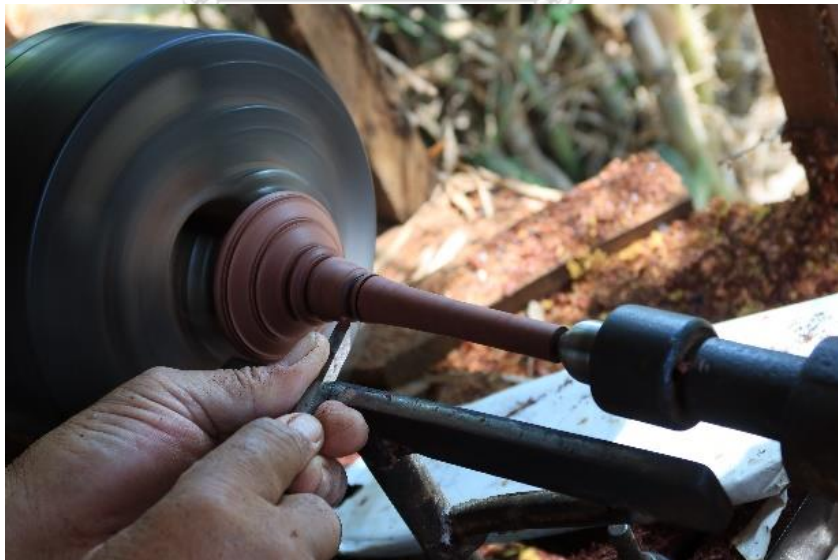
ภาพที่ 136 การใช้มีดเล็บกลึงทรงระฆังคว่ำให้มีความลึก
