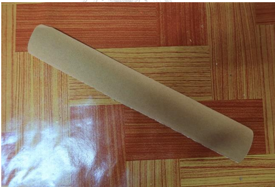
ภาพที่ 74 กระดาษทราย เบอร์ 0 ใช้ขัดเพื่อเก็บรายละเอียดสำหรับงานที่ต้องการความละเอียดสูงสุด ที่มาภาพ : ผู้วิจัยบันทึกภาพเมื่อวันที่ 10 พฤษภาคม 2563
