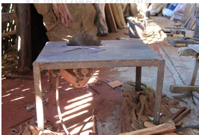
ภาพที่ 56 เลื่อยวงเดือนหรือเครื่องผ่าไม้
