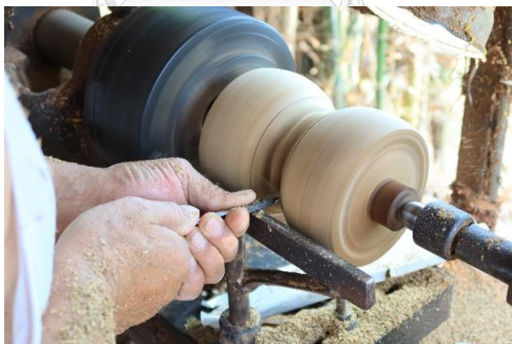
ภาพที่ 118 การใช้มีดแบนกลึงตรงกลางของปั้นเตาเซรวี ที่มาภาพ : ผู้วิจัยบันทึกภาพเมื่อวันที่ 11 พฤษภาคม 2563
