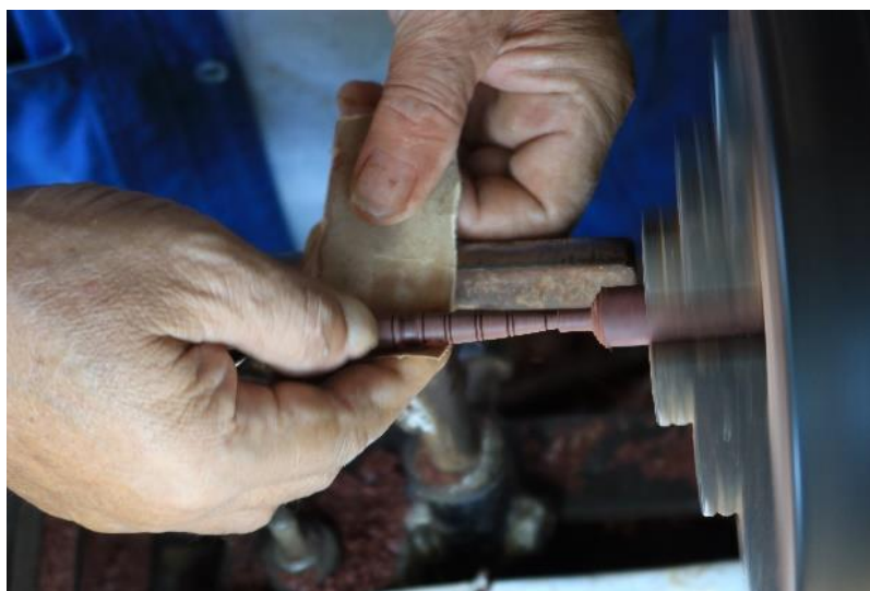
ภาพที่ 159 การขัดชิ้นชะเนาะด้วยกระดาษทรายเบอร์ 0 ที่ชิ้นชะเนาะ ที่มาภาพ : ผู้วิจัยบันทึกภาพเมื่อวันที่ 13 พฤษภาคม 2563
