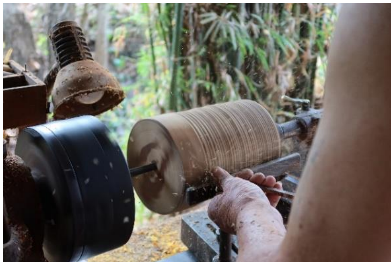
ภาพที่ 113 การใช้มีดเล็บเกลათ่อนไม้สัก
