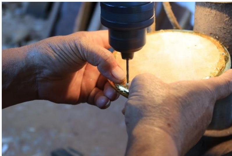
ภาพที่ 179 การเจาะรูที่ขอบบัณเฑาะว์ ที่มาภาพ : ผู้วิจัยบันทึกภาพเมื่อวันที่ 13 พฤษภาคม 2563
