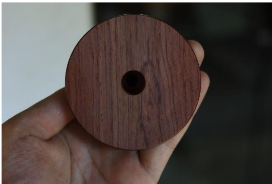
ภาพที่ 149 ส่วนฐานของเสาบัณเฑาะว์ ที่เจียรเสร็จแล้ว ที่มาภาพ : ผู้วิจัยบันทึกภาพเมื่อวันที่ 12 พฤษภาคม 2563
