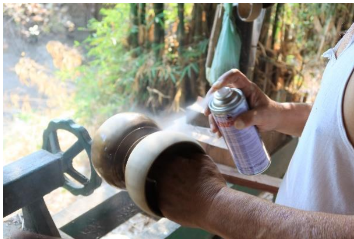
ภาพที่ 125 การพ่นแลคเกอร์ที่หุ่นบ้นเตาะว ที่มาภาพ : ผู้วิจัยบันทึกภาพเมื่อวันที่ 11 พฤษภาคม 2563 เคลือบแลคเกอร์เพื่อรักษาเนื้อไม้และความสวยงาม พ่นแลคเกอร์ทิ้งไว้ประมาณ 3 - 4 ครั้ง ทิ้งไว้ 1 คืน
