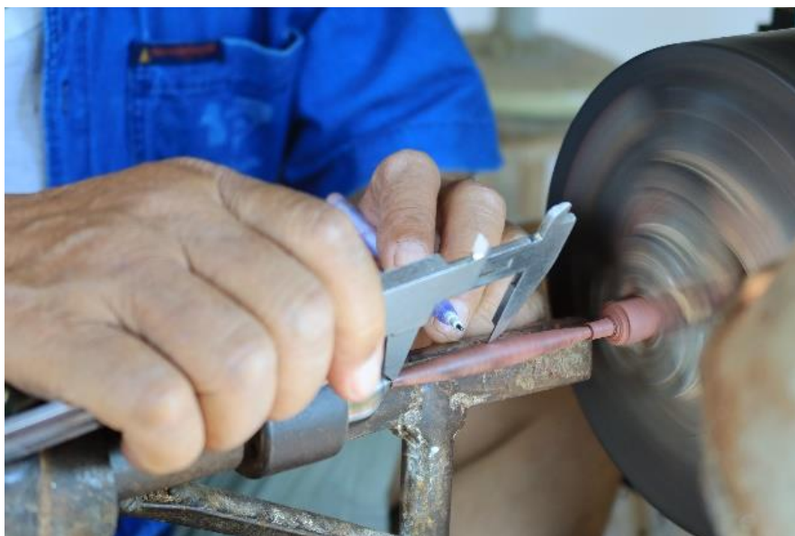
ภาพที่ 155 การใช้เวอร์เนียคาลิปเปอร์วัดขนาดการทำแวนคอดกิว ที่มาภาพ : ผู้วิจัยบันทึกภาพเมื่อวันที่ 13 พฤษภาคม 2563
