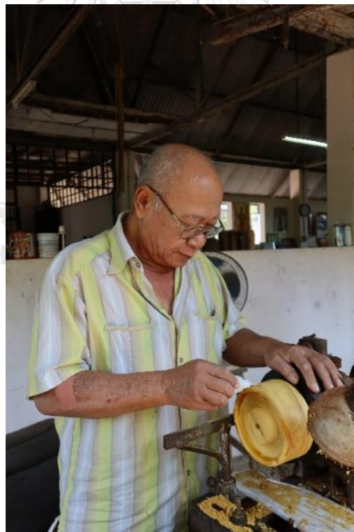
ภาพที่ 102 การหยอดกาวร้อนบนไม้ขนุน ที่มาภาพ : ผู้วิจัยบันทึกภาพเมื่อวันที่ 10 พฤษภาคม 2563
