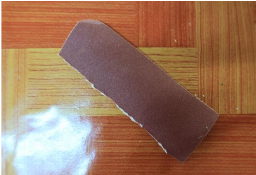
ภาพที่ 73 กระดาษทรายเบอร์ 60 ใช้ขัดเพื่อเก็บรายละเอียดสำหรับงานที่ต้องการความละเอียดมากขึ้น ที่มาภาพ : ผู้วิจัยบันทึกภาพเมื่อวันที่ 10 พฤษภาคม 2563
