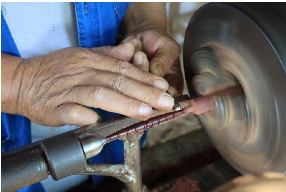
ภาพที่ 163 การใช้มีดเล็บตัดตัวชั้นชะเนาะออกจากแกนไม้ ที่มาภาพ : ผู้วิจัยบันทึกภาพเมื่อวันที่ 13 พฤษภาคม 2563
