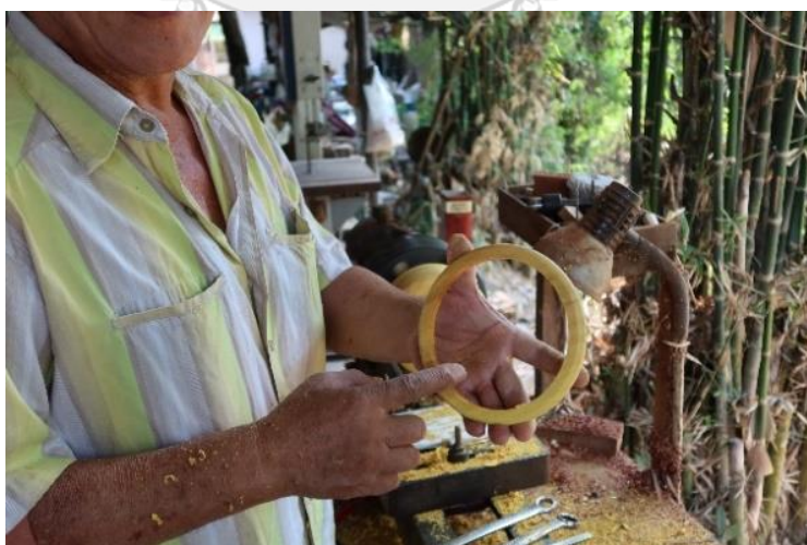
ภาพที่ 104 ขอบของบันฑเตาะว์หลังจากตัดออกจากเครื่องกลึง ที่มาภาพ : ผู้วิจัยบันทึกภาพเมื่อวันที่ 10 พฤษภาคม 2563
