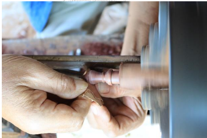
ภาพที่ 172 การใช้กระดาศทรายเบอร์ 120 และเบอร์ 0 ชัดหัวซุน
