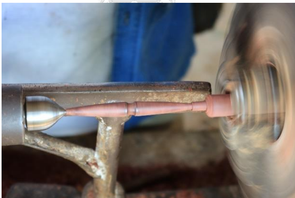
ภาพที่ 156 การทำแวนคอดกิวสำหรับรัดเชือก ที่มาภาพ : ผู้วิจัยบันทึกภาพเมื่อวันที่ 13 พฤษภาคม 2563
