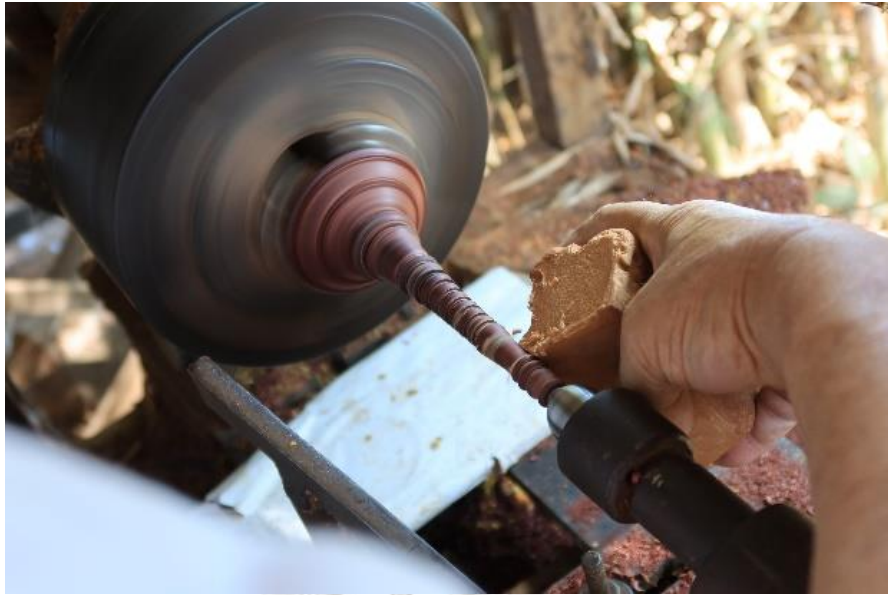
ภาพที่ 143 การขัดไขปลาวาฬที่เสائبัณเฑาะว์ ที่มาภาพ : ผู้วิจัยบันทึกภาพเมื่อวันที่ 12 พฤษภาคม 2563 การใช้กระดาษทรายเบอร์ 120 ขัด 1 รอบ แล้วใช้เบอร์ 0 ขัดอีก 1 รอบ ตามด้วย ไขปลาวาฬขัดต่อเพื่อให้ออกสีเงามันในขณะที่หมุนเครื่องกลิ้งอยู่
