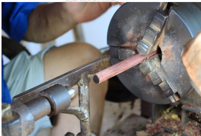
ภาพที่ 152 การนำไม้สำหรับทำชั้นชะเนาะเข้าเครื่องกลึง
