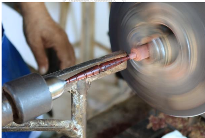
ภาพที่ 162 ชั้นชะเนาะหลังจากถูกขัดด้วยไขปลาวาฬ ที่มาภาพ : ผู้วิจัยบันทึกภาพเมื่อวันที่ 13 พฤษภาคม 2563
