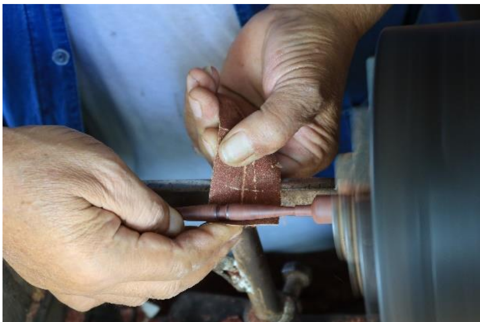
ภาพที่ 157 การใช้กระดาษทรายเบอร์ 120 ซัด ที่มาภาพ : ผู้วิจัยบันทึกภาพเมื่อวันที่ 13 พฤษภาคม 2563
