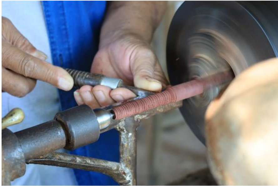
ภาพที่ 153 การใช้มีดมีดปลายแหลมกลึงให้มีขนาดเล็กกลึงเป็นร่อง ที่มาภาพ : ผู้วิจัยบันทึกภาพเมื่อวันที่ 13 พฤษภาคม 2563
