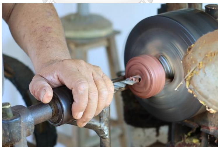
ภาพที่ 130 การเจาะรูด้านปลาย ที่มาภาพ : ผู้วิจัยบันทึกภาพเมื่อวันที่ 12 พฤษภาคม 2563
