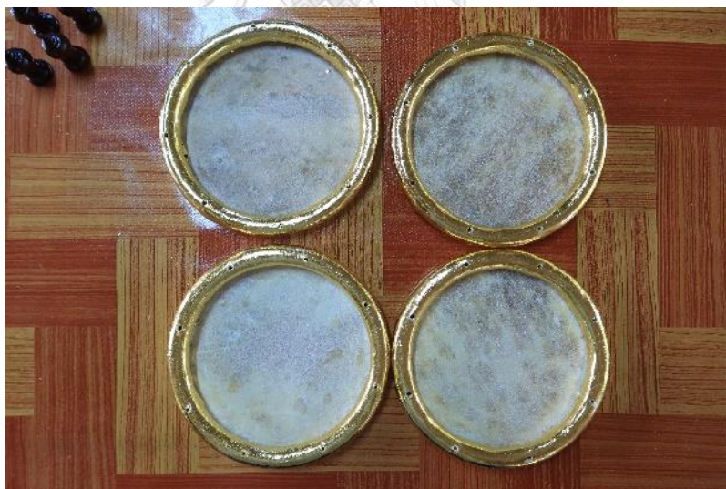
ภาพที่ 180 หน้ากลองหลังจากเจาะรูที่ขอบเสร็จแล้ว ที่มาภาพ : ผู้วิจัยบันทึกภาพเมื่อวันที่ 16 พฤษภาคม 2563
