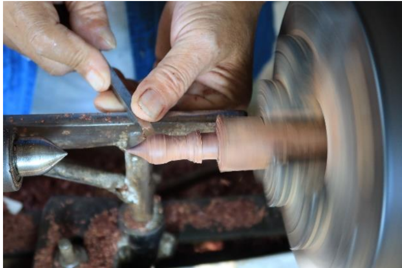
ภาพที่ 169 การใช้มีดปลายแหลมกลึงโครงหัวขุน ที่มาภาพ : ผู้วิจัยบันทึกภาพเมื่อวันที่ 13 พฤษภาคม 2563
