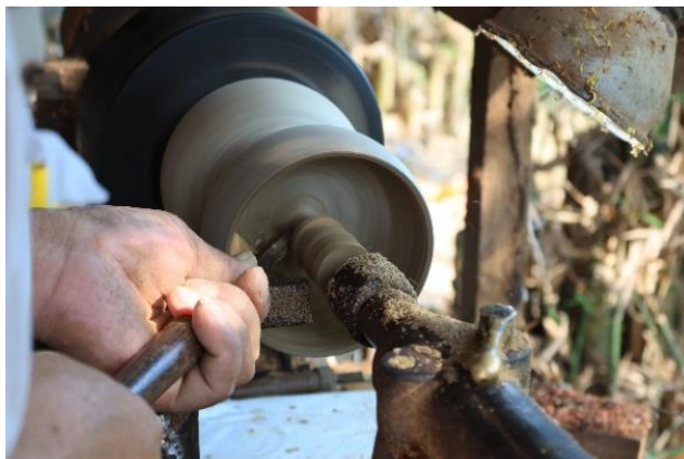
ภาพที่ 119 การใช้มีดเล็บบำรุงขาง
