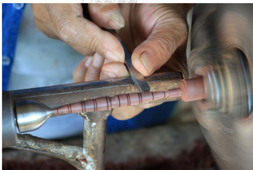
ภาพที่ 158 การใช้มีดหลายแหลมทำร่อง ที่มาภาพ : ผู้วิจัยบันทึกภาพเมื่อวันที่ 13 พฤษภาคม 2563
