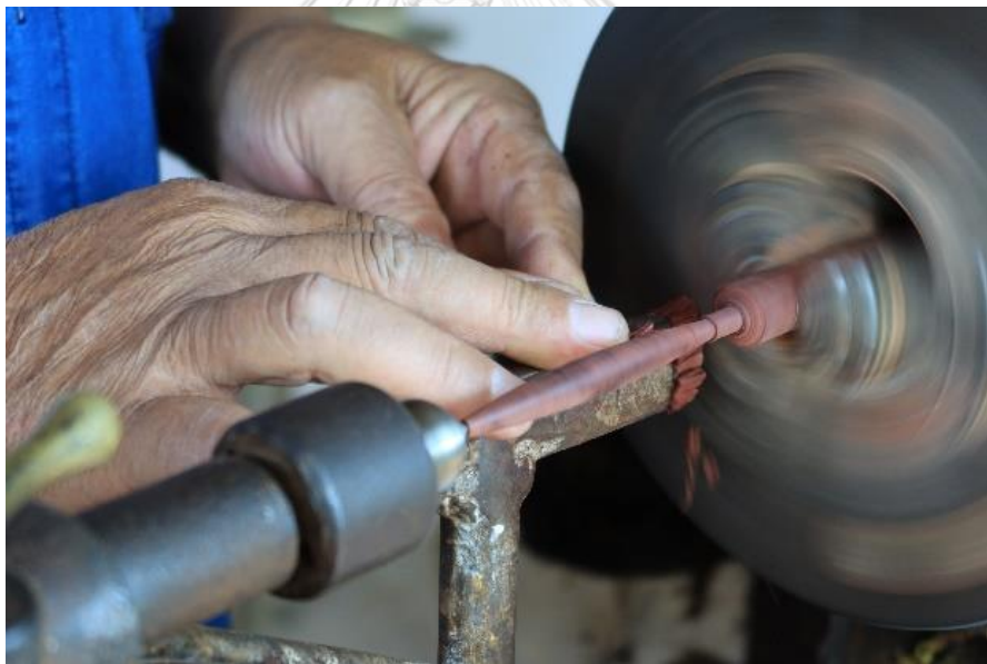
ภาพที่ 154 การใช้มีดแบนเก็บรายละเอียดให้เรียบ ที่มาภาพ : ผู้วิจัยบันทึกภาพเมื่อวันที่ 13 พฤษภาคม 2563
