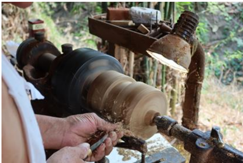
ภาพที่ 117 การใช้มีดแหลมกลึงด้านข้างของหุ่นปั้นเตาเซรวี ที่มาภาพ : ผู้วิจัยบันทึกภาพเมื่อวันที่ 11 พฤษภาคม 2563
