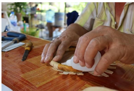
ภาพที่ 109 การใช้กาวยร้อนติดหนังและวงของขอบไม้ ที่มาภาพ : ผู้วิจัยบันทึกภาพเมื่อวันที่ 10 พฤษภาคม 2563
