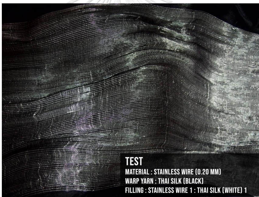
รูปภาพที่ 46 การทดลองการทอด้วยสแตนเลสขนาดหน้าตัด 0.20 มิลลิเมตร ผสมด้วยเส้นไหม โดยใช้อัตราส่วนของสแตนเลสและเส้นไหม 1:1 เส้น
