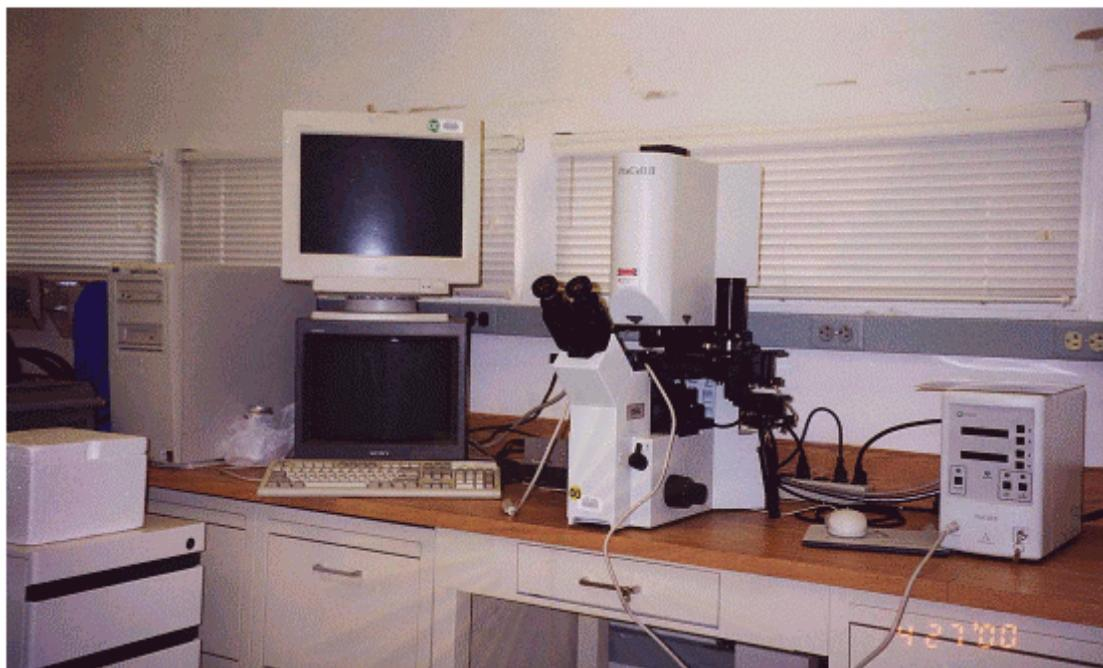
**Figure 1.3:** *Laser Capture Microdissection apparatus*
