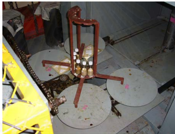
รูปที่ 3.2 รูปตำแหน่ง Rack วางในเครื่องฉายรังสี
