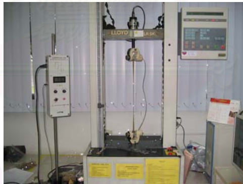
รูปที่ 3.3 รูปเครื่องทดสอบความต้านทานการดึงขนาด Universal Testing Machine รุ่น LR 5K จากบริษัท LLOYD INSTRUMENTS
