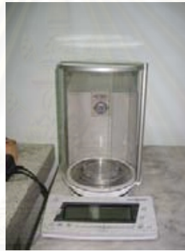
รูปที่ 3.4 รูปเครื่องชั่งทศนิยม 5 ตำแหน่ง
