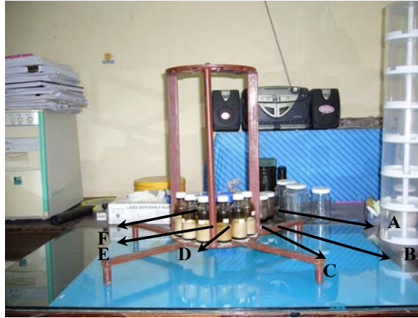
รูปที่ 3.1 รูปตำแหน่งที่ใช้วางขวดใน Rack ที่ใช้ฉายรังสี
