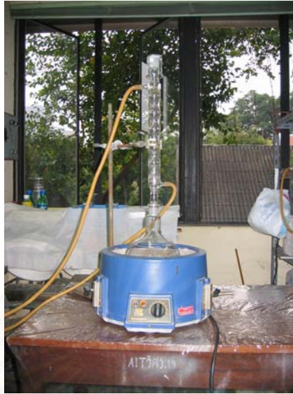
รูปที่ 3.6 รูปการทำ Reflux เพื่อหาค่าความเป็นเจล
