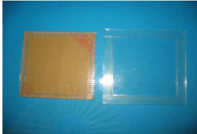
รูปที่ 3.10 รูปแผ่น Acrylic มีขอบ เจาะรูที่ขอบทุกด้าน แต่ละรูห่างกัน 5 มิลลิเมตร ขนาด 15 ×15 เซนติเมตร (ด้านซ้าย) และแผ่นกระจกขนาด 15 ×15 เซนติเมตร (ด้านขวา)
