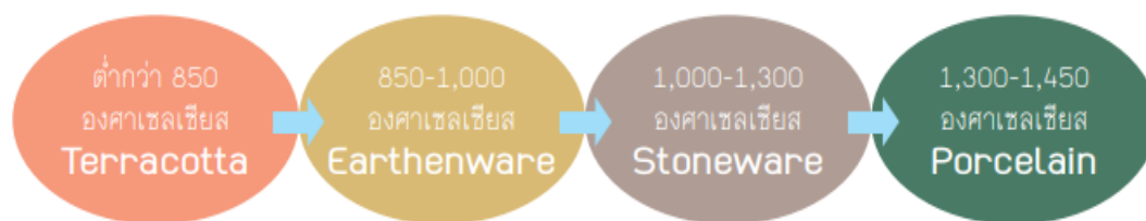
ภาพที่ 14 ชนิดของดินเผาตามอุณหภูมิที่ใช้ในการเผา
