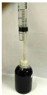
รูปที่ 3.12 การตรวจวัดปริมาณก๊าซชีวภาพ
