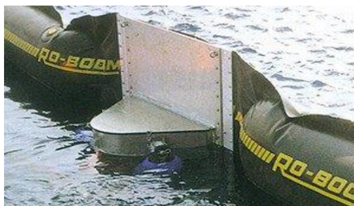
รูปที่ 4.41 ทุ่นกักน้ำมันแบบร่วม (RO – Skim)
