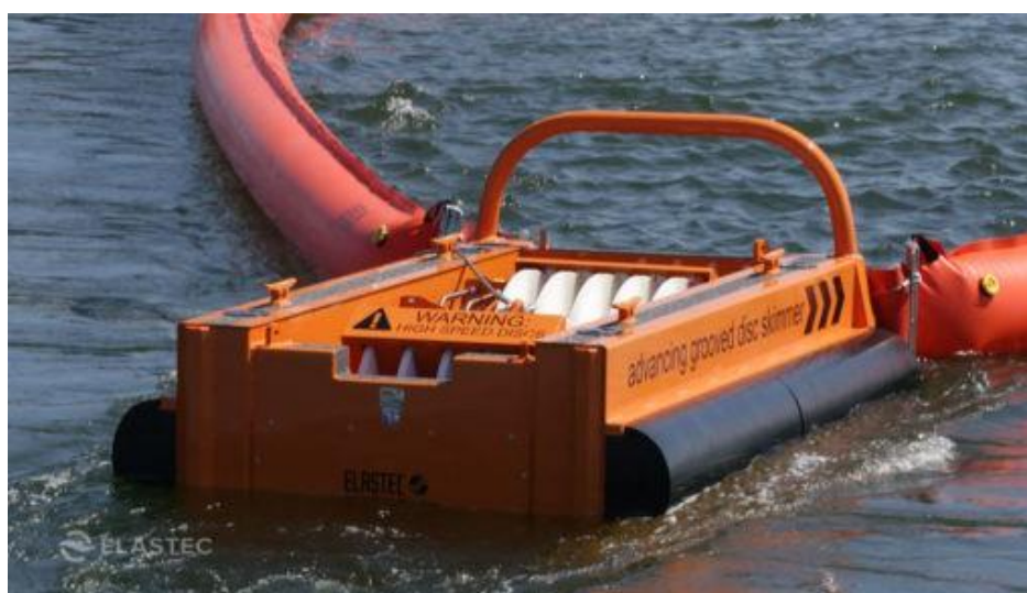
รูปที่ 4.44 การใช้งานเครื่องดูดคราบน้ำมันแบบดิสก์ (Disc Skimmers)
