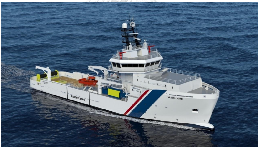
รูปที่ 5.6 เรือป้องกันและขจัดคราบน้ำมันในทะเลในรูปแบบของเรือกิ่งอเนกประสงค์ขนาด 70 เมตร ที่มา : บริษัท อิตาลีไทย มารีน จำกัด (2563)
