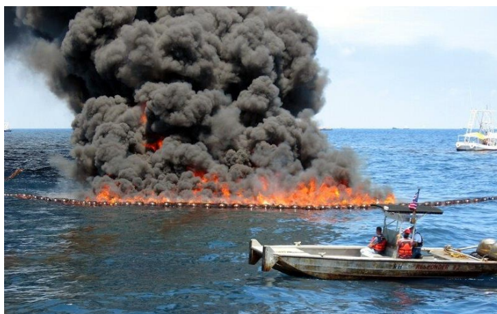
รูปที่ 4.39 Pyro Boom ขณะใช้ในการปฏิบัติการขจัดคราบน้ำมันในทะเลด้วยวิธีการเผา ที่มา : DESMI (2020)
