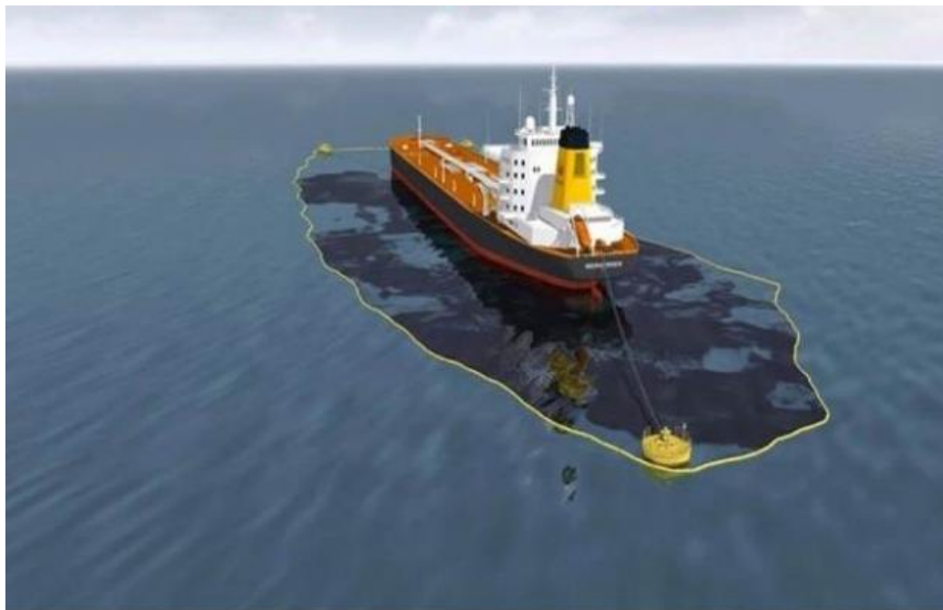
รูปที่ 1.3 การใช้ทุ่นกักน้ำมัน และเครื่องดูดคราบน้ำมัน
