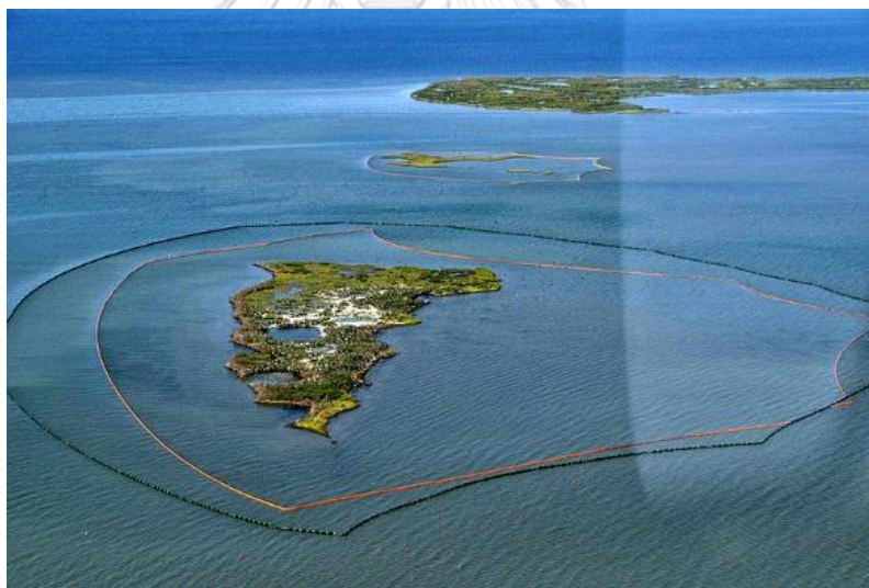
รูปที่ 2.7 การใช้ทุ่นกักน้ำมันล้อมรอบเกาะ New Harbor, La. บริเวณอ่าวเม็กซิโก ที่มา : กองทัพเรือสหรัฐฯ (2010)
