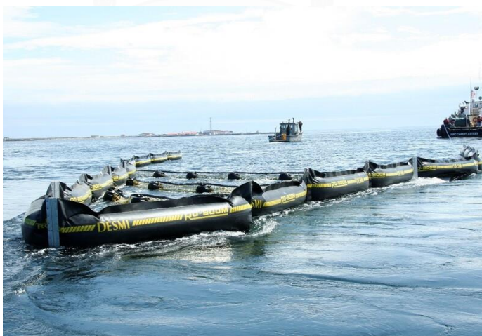
รูปที่ 4.38 การใช้งานทุ่นกักน้ำมันแบบ RO – Kite ที่ออกแบบใหม่เรียกว่า Speed – Sweep เพื่อเพิ่มประสิทธิภาพในการปฏิบัติการ
