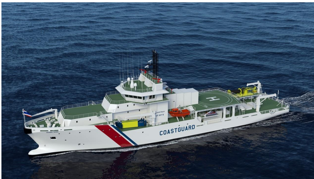
รูปที่ 5.5 เรือป้องกันและขจัดคราบน้ำมันในทะเลในรูปแบบของเรือเนกประสงค์ขนาด 90 เมตร รองรับการปฏิบัติงานได้หลายภารกิจ เช่น ช่วยเหลือผู้ประสบภัย ดับเพลิง กู้ซ่อม
