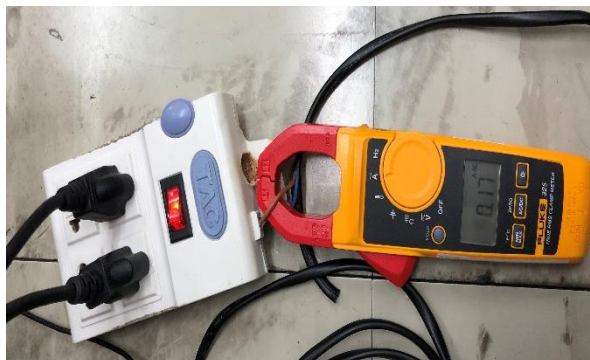
Figure 19 ทำการวัดกระแสไฟฟ้าของคอมพิวเตอร์
