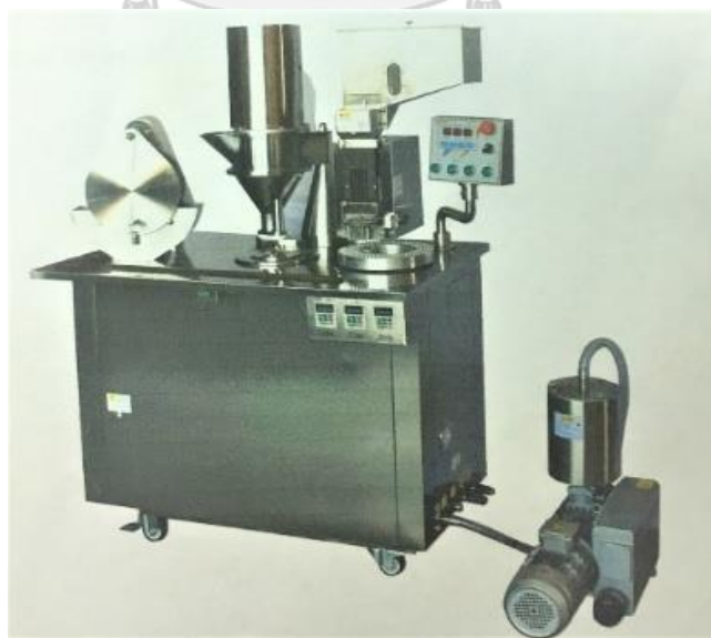
รูปที่ 12 เครื่องบรรจุแคปซูลกึ่งอัตโนมัติ 300 เม็ด
