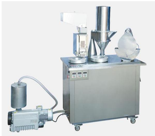
รูปที่ 11 เครื่องบรรจุแคปซูลกึ่งอัตโนมัติ 150 เม็ด
