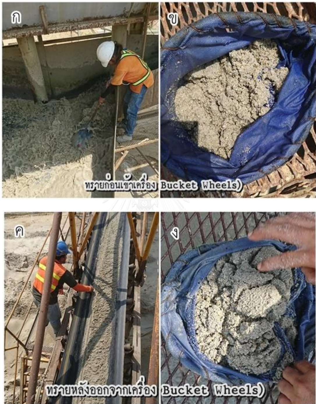
รูปที่ 3.8 ภาพแสดงจุดที่เก็บตัวอย่างจาก บ่อทรายซีเมนต์สัร้อย จ.อ่างทอง ก= การเก็บตัวอย่างทรายก่อนเข้าเครื่อง Bucket wheel ข = ลักษณะทรายก่อนเข้าเครื่องคัดขนาด ค= การเก็บตัวอย่างทรายหลังจากเครื่อง Bucket wheel บนสายพาน และ ง=ลักษณะทรายหลังเข้าเครื่อง Bucket wheel
