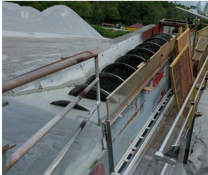
รูปที่ 2.9 เครื่องคัดขนาดแบบ Spiral Classifier
