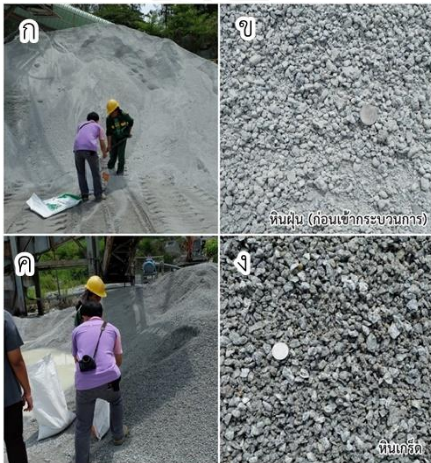
รูปที่ 3.6 ภาพแสดงจุดที่เก็บตัวอย่าง บริษัทสโตนวัน ก = การเก็บตัวอย่างหินฝุ่นก่อนเข้าโรงล้างโดยวิธีการสูบลม ข = หินฝุ่นแกรนิตก่อนเข้ากระบวนการ ค = การเก็บตัวอย่างหินแกรนิตโดยวิธีการสูบลม และ
