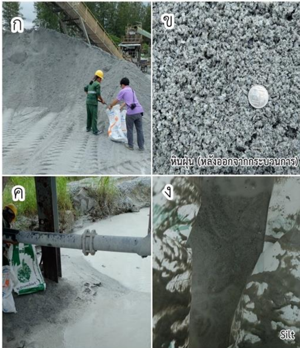
รูปที่ 3.7 ภาพแสดงจุดที่เก็บตัวอย่าง จากบริษัทสโตนวัน (ต่อ) ก= การเก็บตัวอย่างหินฝุ่นหลังเข้าโรง ล้างโดยวิธีการสูม ข = หินฝุ่นแกรนิต (หลังออกจากกระบวนการล้าง) ค= การเก็บตัวอย่างทราย ขนาดSilt โดยวิธีแบบสูม และ ง = ทรายขนาดSilt
