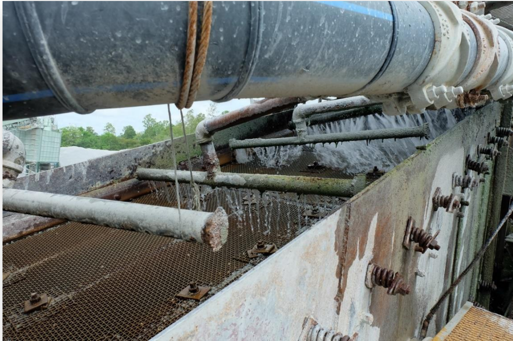
รูปที่ 4. 6 ตะแกรงคัดขนาดในโรงล้างหินฝุ่นแกรนิต
