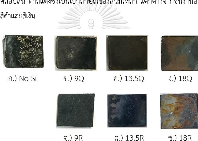
รูปที่ 4. 1 ชิ้นงานที่ผ่านกระบวนการอะลูมิเนียมในซิงที่อุณหภูมิ 1000°C เป็นเวลา 2.25 ชั่วโมง
