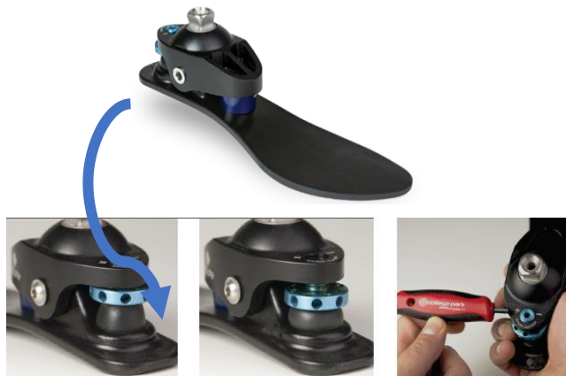
รูปที่ 2-36 การปรับความแข็งอ่อนของเท้าเทียมtribometerด้วยการขันสกรูอัดลูกยาง ด้วยหลักการ precompression [56]
