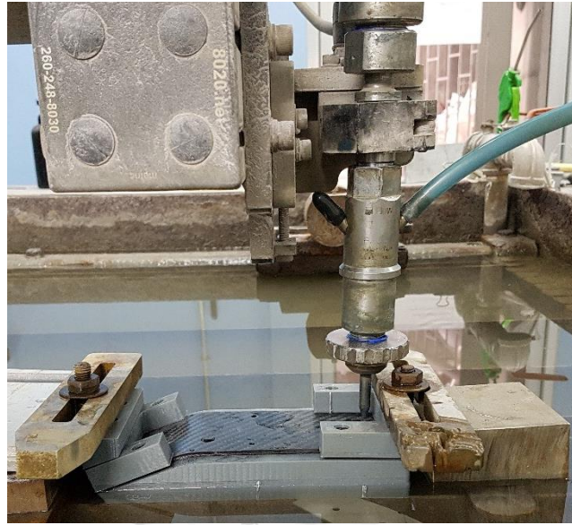
รูปที่ 4-11 การตัดชิ้นงานด้วยWaterjet cutting machine
