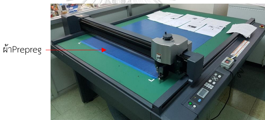
รูปที่ 4-5 การใช้เครื่องFlat Bed Cutting Plotter ตัดผ้าPrepreg
