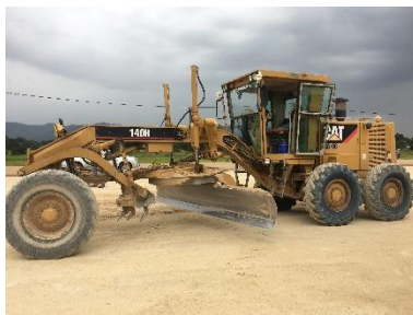
รูปที่ 2.6 ตัวอย่างรถเกลี่ยดินแบบแบบ 6 ล้อขับเคลื่อน 4 ล้อ
