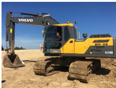
รูปที่ 2.4 ตัวอย่างรถขุดไฮดรอลิกแบบเข้าหาตัวรถชนิดตีนตะขาบ
