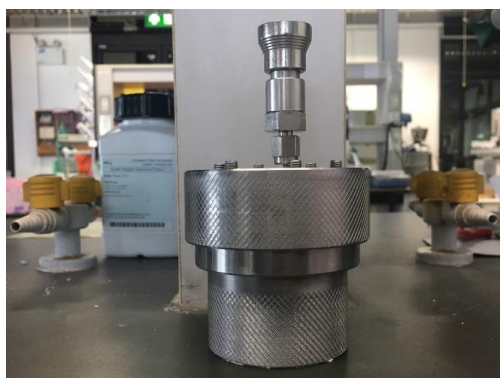
รูปที่ 3.6 (ซ้าย) เครื่องปฏิกรณ์อัตโนมัติที่อัดความดันและ (ขวา) ชุดอุปกรณ์อัดความดัน
