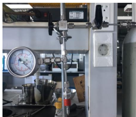
รูปที่ 3.6 (ซ้าย) เครื่องปฏิกรณ์อัตโนมัติที่อัดความดันและ (ขวา) ชุดอุปกรณ์อัดความดัน
