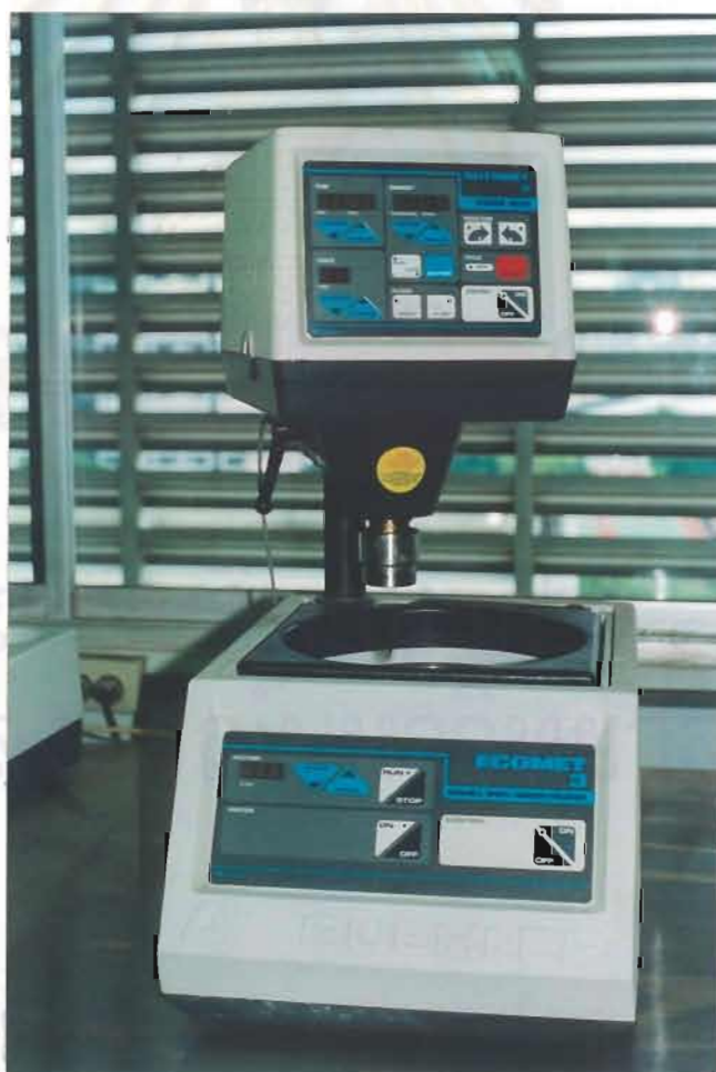
ภาพที่ 4 เครื่องขัดฟัน ( Isomet 2000 specimen preparation equipment)
