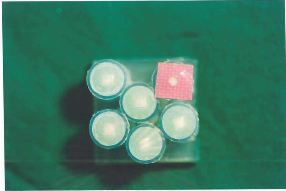
ภาพที่ 7 ติดกระดาษกาวที่เจาะรูขนาดเส้นผ่าศูนย์กลาง 1.8 มิลลิเมตร โดยให้รูอยู่กึ่งกลางของ ชั้นพื้นที่ตัด จากนั้นใช้เบอร์นิชเซอร์ชนิดปลายกลม (Ball burnisher) รีดกระดาษกาวให้ แนบกับผิวเคลือบฟันให้สนิท
