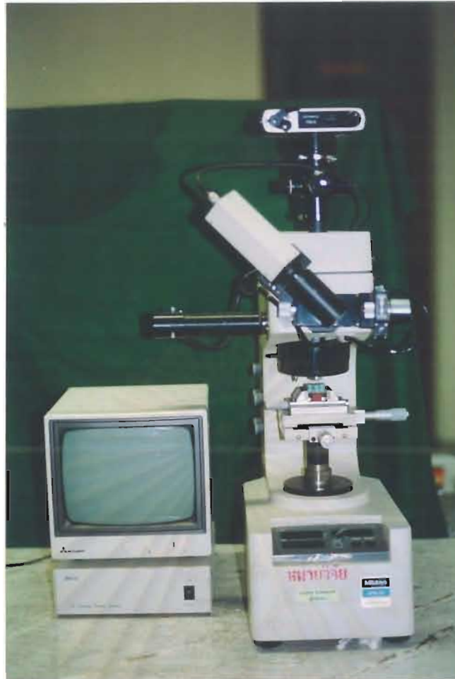
ภาพที่ 5 เครื่องวัดความแข็งแบบจุลภาค ( Microhardness tester, Mitutoyo MVK-G3 )
