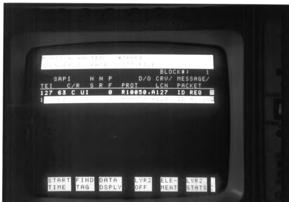
รูป 5.2 4 เฟรมโต้ตอบระหว่างหน่วยเชื่อมต่อโครงข่าย ISDN สำหรับเครื่องคอมพิวเตอร์ส่วนบุคคลผ่านทางพอร์ต RS232 และ LT-S เพื่อร้องขอกำหนดหมายเลข TEI ซึ่งตรวจจับได้โดย Protocol Analyzer
