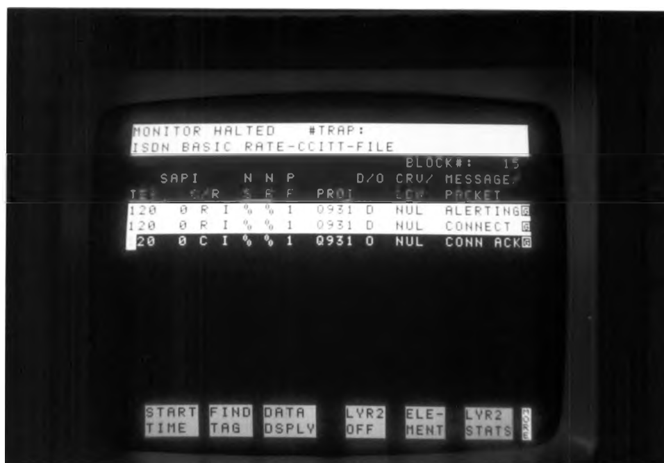
รูป 5.6 เฟรมโต้ตอบระหว่างหน่วยเชื่อมต่อโครงข่าย ISDN สำหรับเครื่องคอมพิวเตอร์ส่วนบุคคลผ่านทางพอร์ต RS232 และ LT-S เพื่อขอเริ่มต้นการเชื่อมต่อในช่องสัญญาณ B ซึ่งตรวจจับได้โดย
