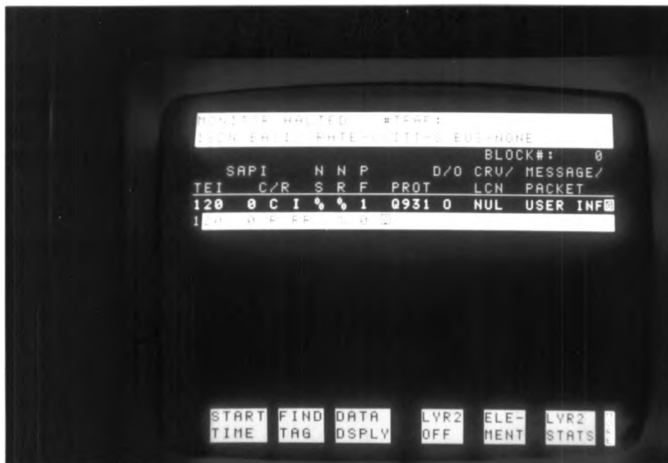
รูป 5.7 เฟรมโต้ตอบระหว่างหน่วยเชื่อมต่อโครงข่าย ISDN สำหรับเครื่องคอมพิวเตอร์ส่วนบุคคลผ่านทางพอร์ต RS232 และ LT-S เพื่อส่งข้อมูลในช่องสัญญาณ B ซึ่งตรวจจับได้โดย Protocol Analyzer
