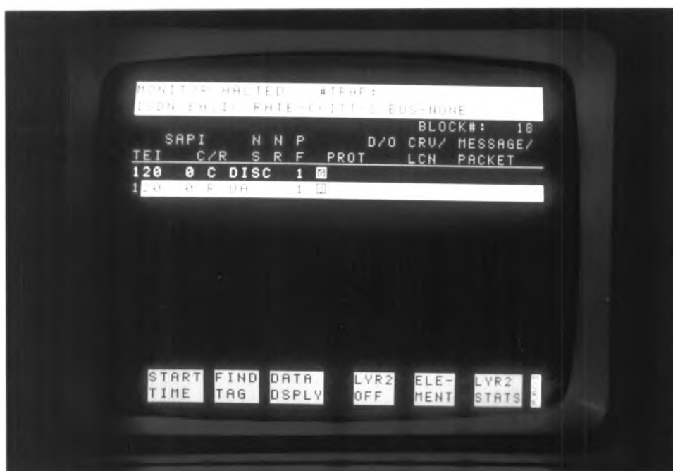
รูป 5.5 เฟรมโต้ตอบระหว่างหน่วยเชื่อมต่อโครงข่าย ISDN สำหรับเครื่องคอมพิวเตอร์ส่วนบุคคลผ่านทางพอร์ต RS232 และ LT-S เพื่อขอสิ้นสุดการเชื่อมต่อในช่องสัญญาณ D ซึ่งตรวจจับได้โดย
