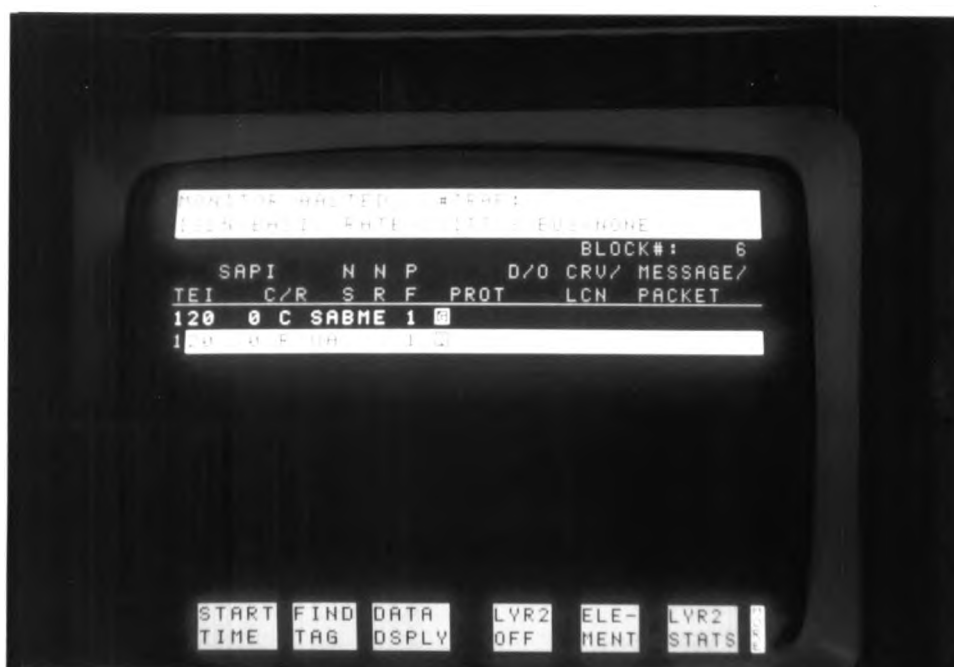
รูป 5.3 เฟรมโต้ตอบระหว่างหน่วยเชื่อมต่อโครงข่าย ISDN สำหรับเครื่องคอมพิวเตอร์ส่วนบุคคลผ่านทางพอร์ต RS232 และ LT-S เพื่อขอเริ่มต้นการเชื่อมต่อในช่องสัญญาณ D ซึ่งตรวจจับได้โดย
