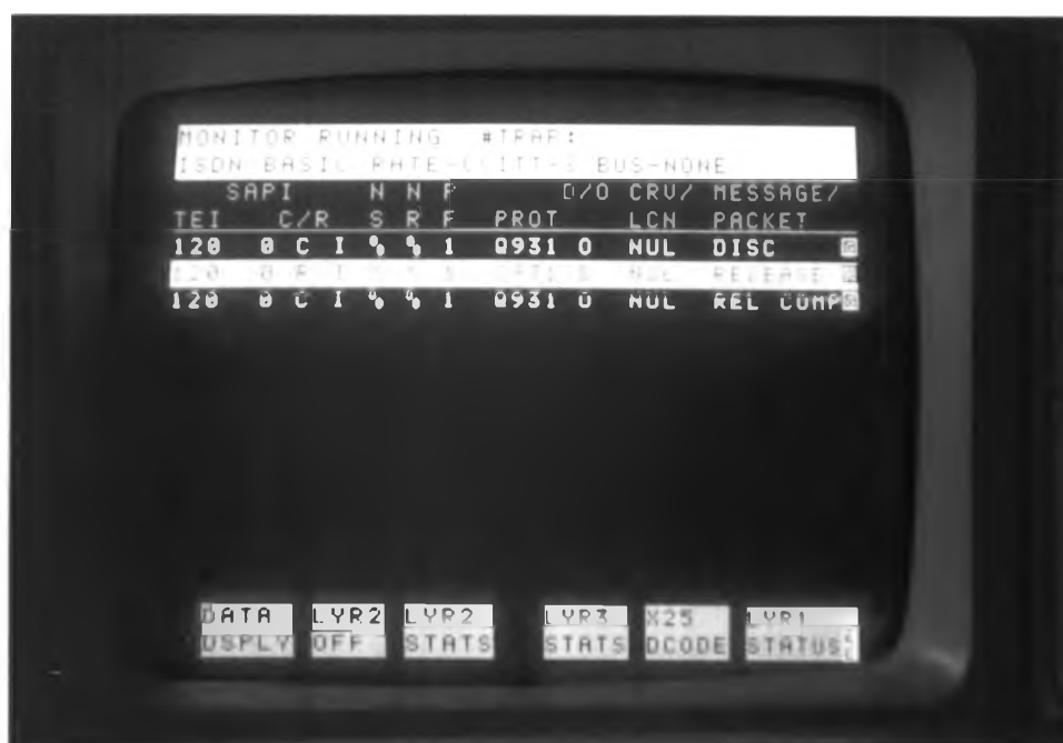
รูป 5.8 เฟรมโต้ตอบระหว่างหน่วยเชื่อมต่อโครงข่าย ISDN สำหรับเครื่องคอมพิวเตอร์ส่วนบุคคลผ่านทางพอร์ต RS232 และ LT-S เพื่อขอสิ้นสุดการเชื่อมต่อในช่องสัญญาณ B ซึ่งตรวจจับได้โดย
