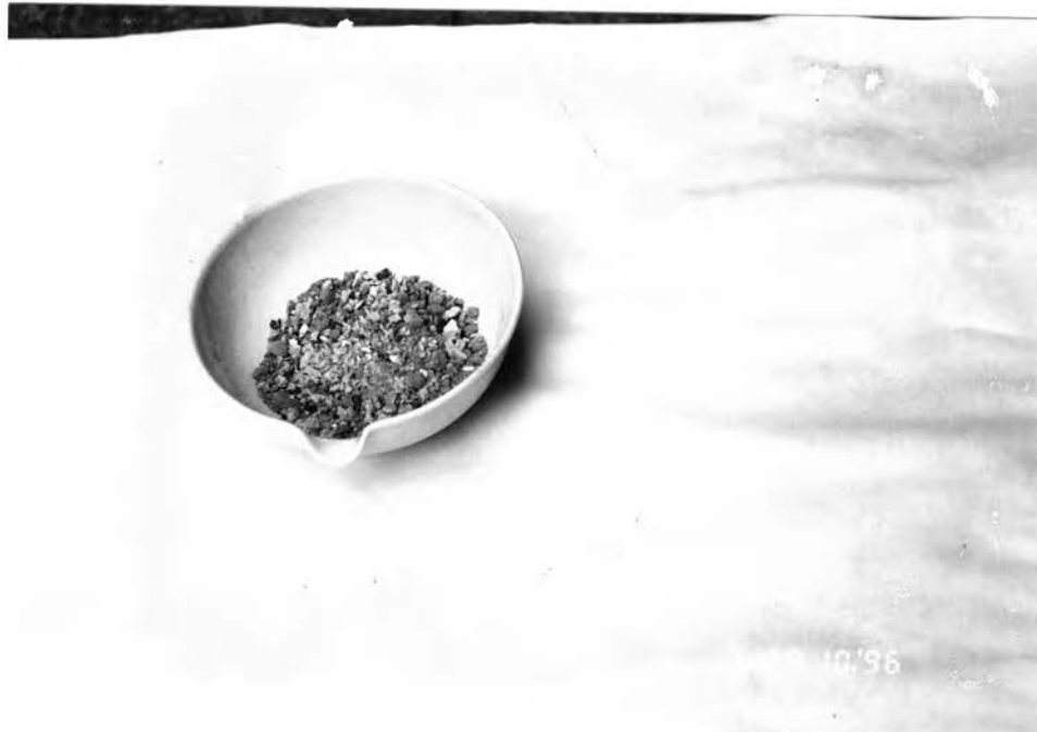
รูปที่ ผ4 ซี้เถ้าหลังการเผาที่อุณหภูมิ 1200 °ซ
