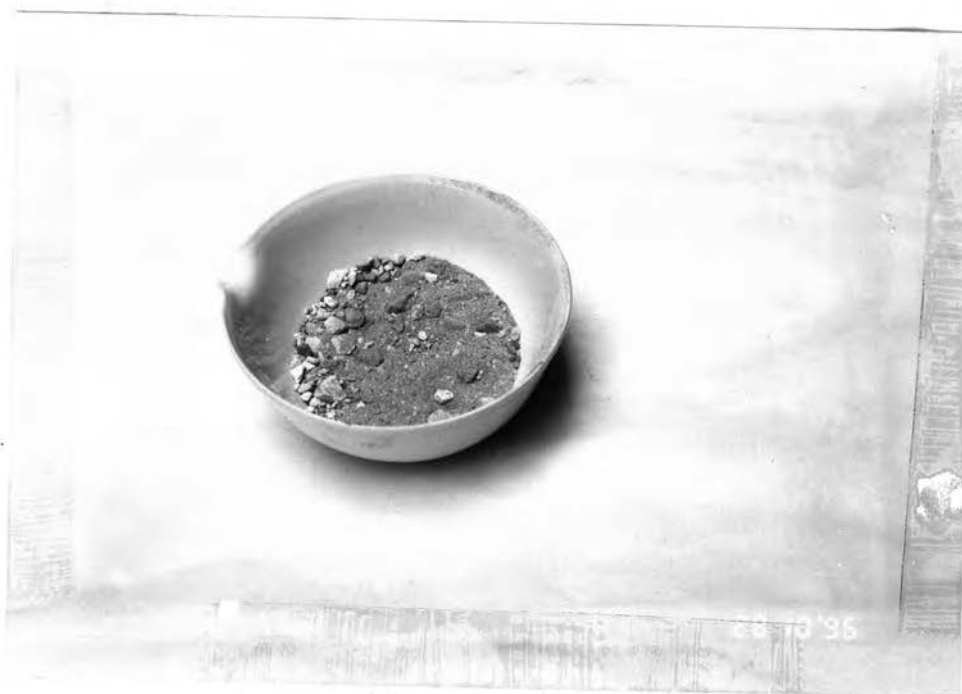
รูปที่ ผ3 ซี้เถ้าหลังการเผาที่อุณหภูมิ 800 °ซ
