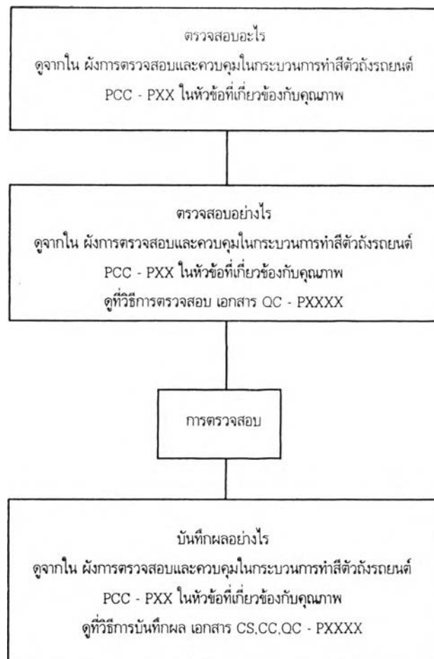
รูปที่ 6.20 ผังแสดงขั้นตอนการตรวจสอบคุณภาพในกระบวนการทำสีตัวถังรถยนต์
