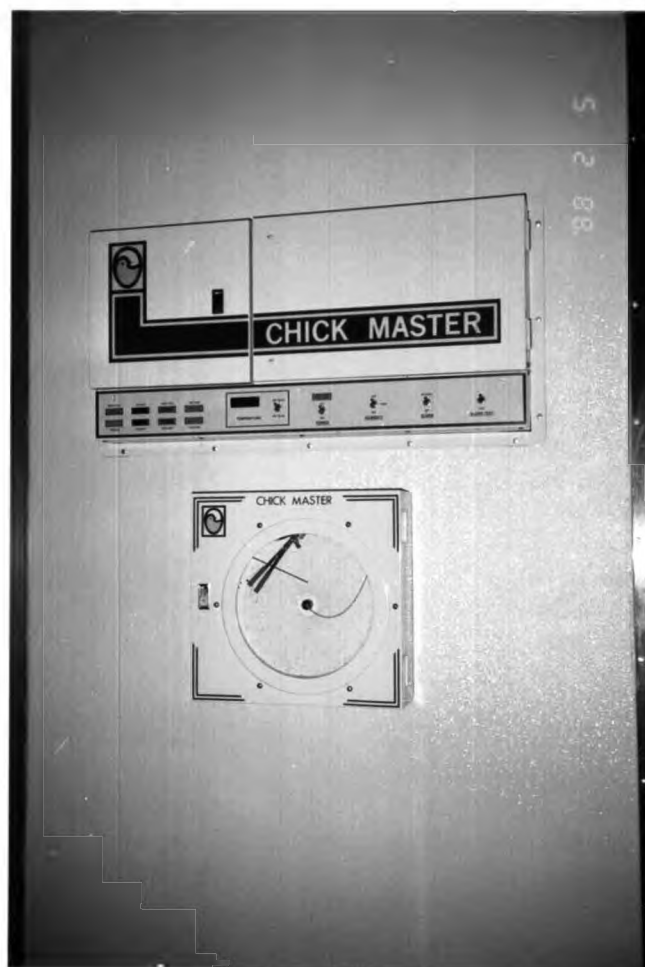
ภาพที่ 3.9 ภาพเครื่องควบคุมอุณหภูมิและความชื้นในตู้พัก
