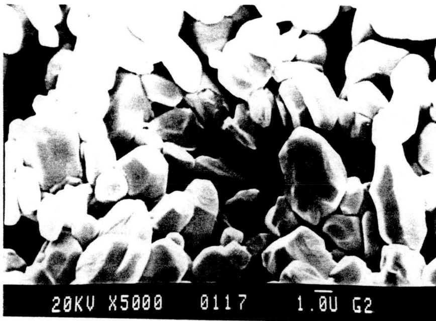
ก) เดิมสารช่วยซินเทอร์คือคอปเปอร์ออกไซด์ 2 เปอร์เซ็นต์โดยน้ำหนัก
