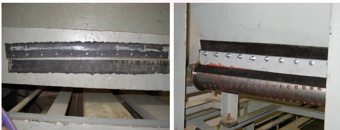
รูป ข-5 ภาพแผ่นยางเครื่องโรยทราย ก่อน-หลัง การปรับปรุง
