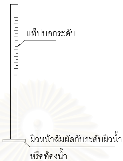
รูป ก-13 แบบจำลองของแท่งวัดระดับ (Staff gauge)
