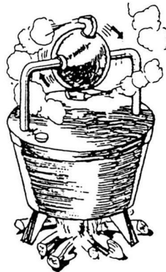
รูปที่ 9 เครื่องมือ Hero's aeolipile
