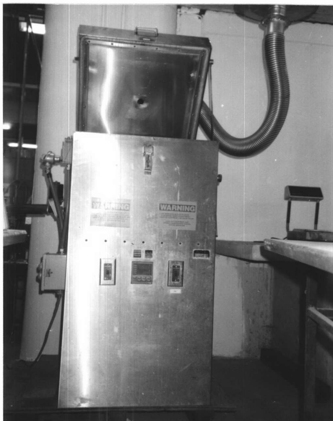
รูปที่ 3.4 Cryo Test Chamber ที่ใช้แช่เยือกแข็ง
