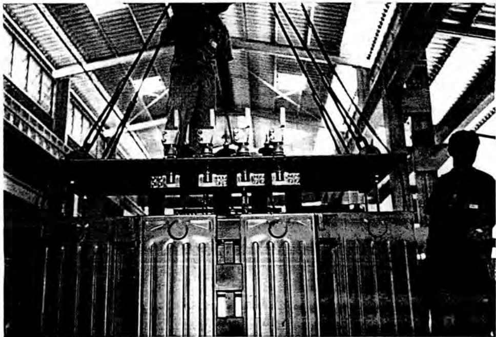
รูปที่ 4.15 การประกอบหม้อแปลงลงถึง
