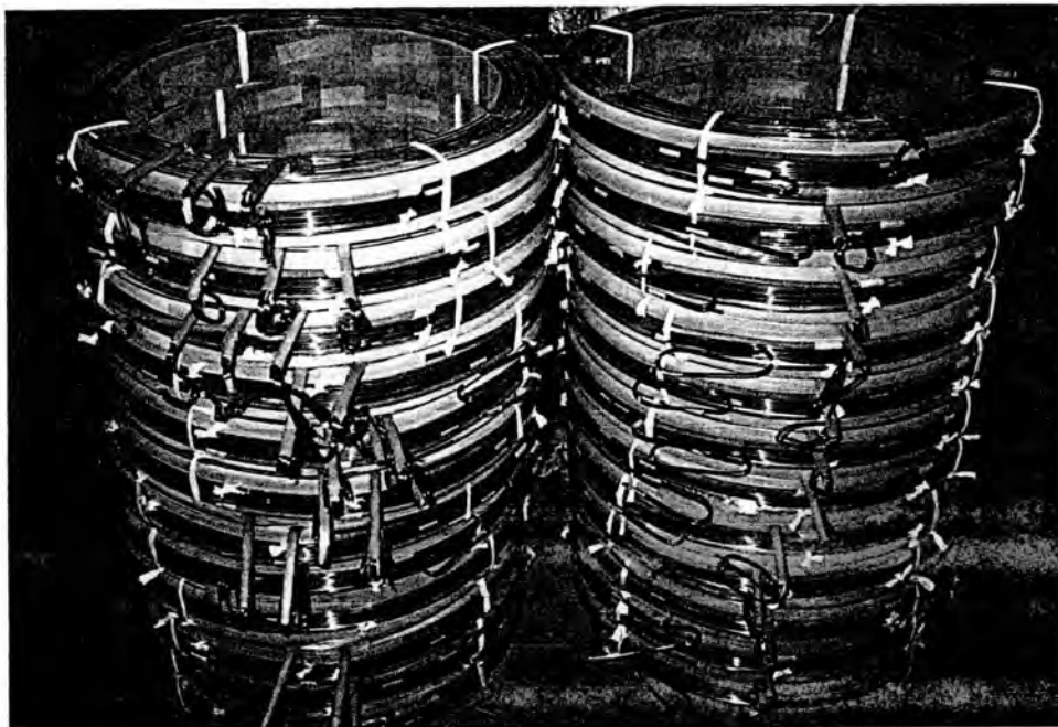
รูปที่ 4.2จ ขดลวดที่พันเสร็จแล้วพร้อมที่จะประกอบต่อไป
