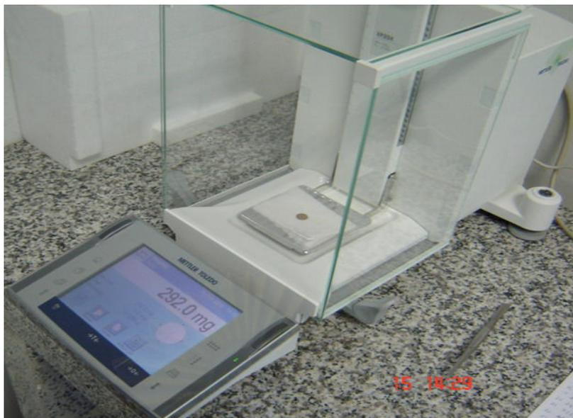
รูปที่ 3.12 ภาพการชั่งน้ำหนัก stainless steel disc โดยเครื่องชั่งดิจิทัล
