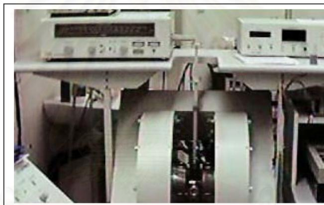
รูปที่ 2.1 อุปกรณ์ของเครื่อง Electron Spin Resonance
