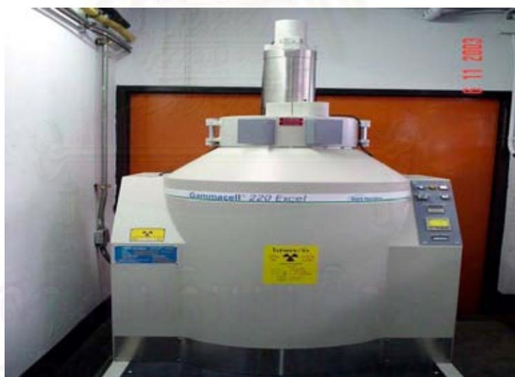
รูปที่ 3.4 อุปกรณ์เครื่องกำเนิดรังสีแกมมา รุ่น Gammacell 220 Excell
