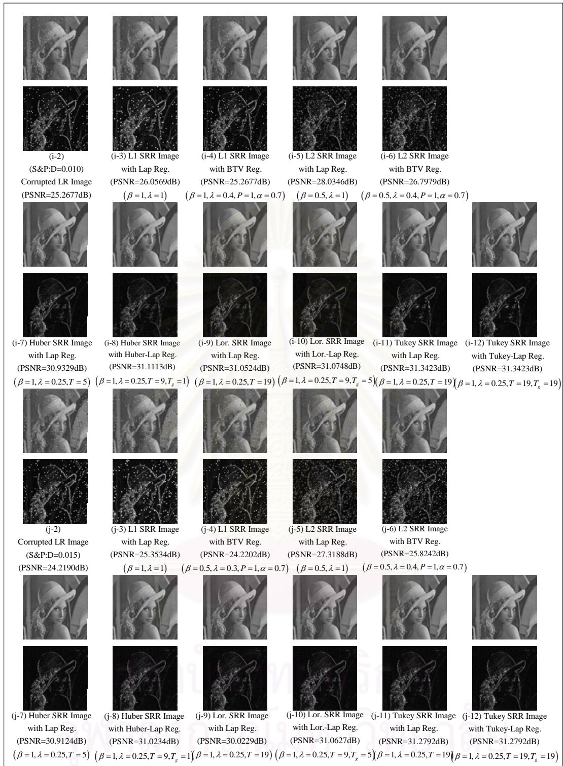
รูปที่ 7 ผลการทดลองของการสร้างภาพความละเอียดสูงยิ่ง : ภาพ Lena (ต่อ)
