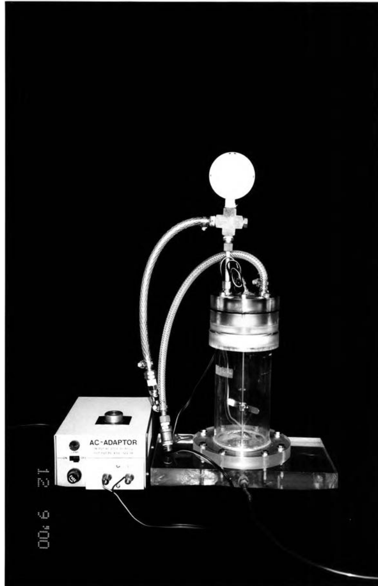
รูปที่ 35 (b) ภาพถ่ายเครื่องปฏิกรณ์อัลตราฟิลเทรชันที่ออกแบบสร้าง
