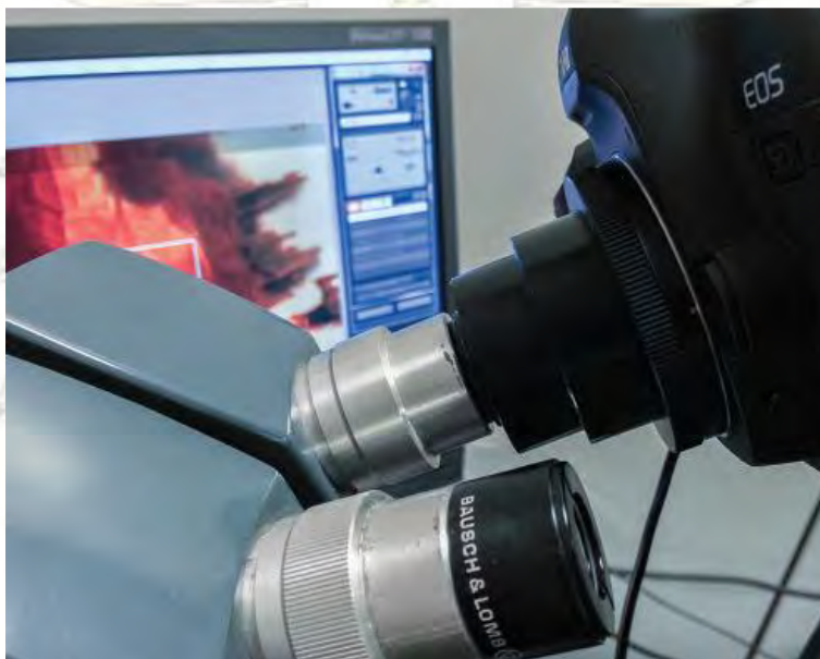
รูปที่ 1.5 กล้องดิจิทัล DSLR ต่อเข้ากับกล้องจุลทรรศน์ที่ไม่มี Trinocular port ทางเลนส์ใกล้ตา
