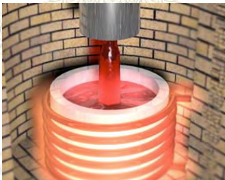
รูปที่ 2.13 แท่งทับทิมสังเคราะห์โดยวิธี The melt-pulled (Czochralski)
