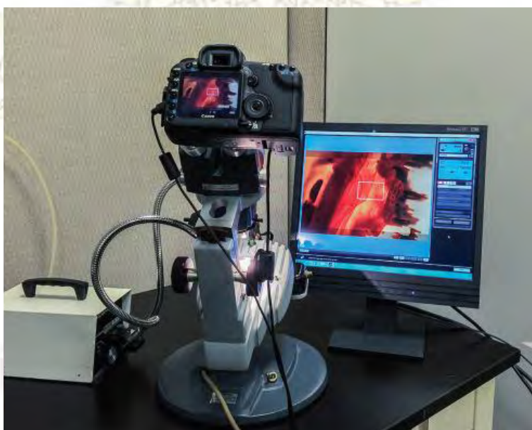
รูปที่ 1.6 การปรับโฟกัสและตำแหน่งภาพของตัวอย่างโดย Software สังเกตภาพผ่านจอคอมพิวเตอร์
