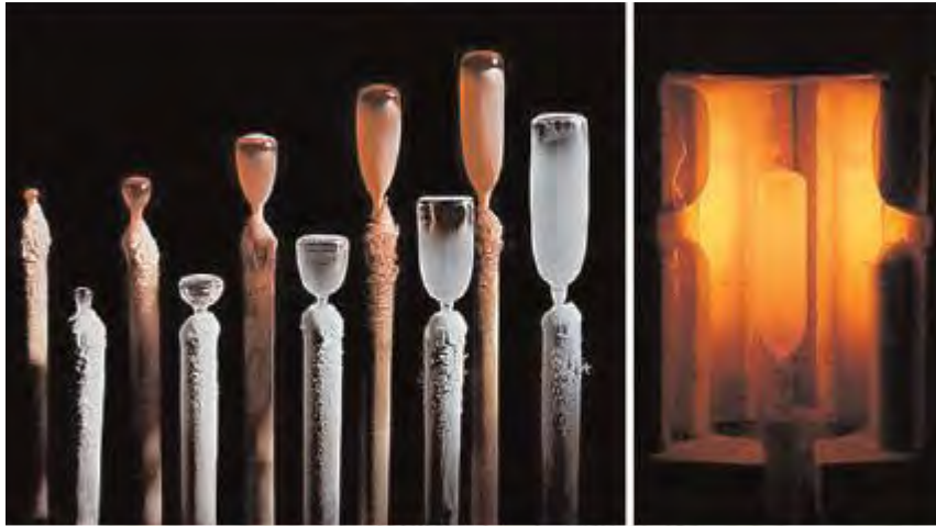
รูปที่ 2.10 แท่งคอรัันดัมสังเคราะห์โดยวิธี Frame Fusion (Verneuil)
