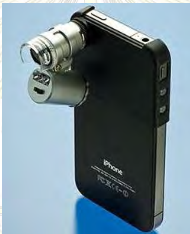
รูปที่ 1.7 กล้องจุลทรรศน์ขนาดเล็กพร้อมหลอด LEDs ติดตั้งบริเวณกล้องสมาร์ทโฟน
