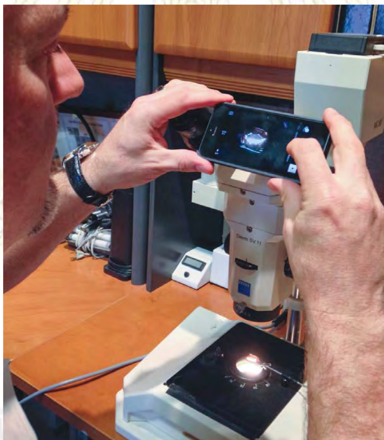
รูปที่ 1.1 การใช้สมาร์ทโฟนถ่ายภาพไมโครสโคปจากกล้องจุลทรรศน์อัญมณี
