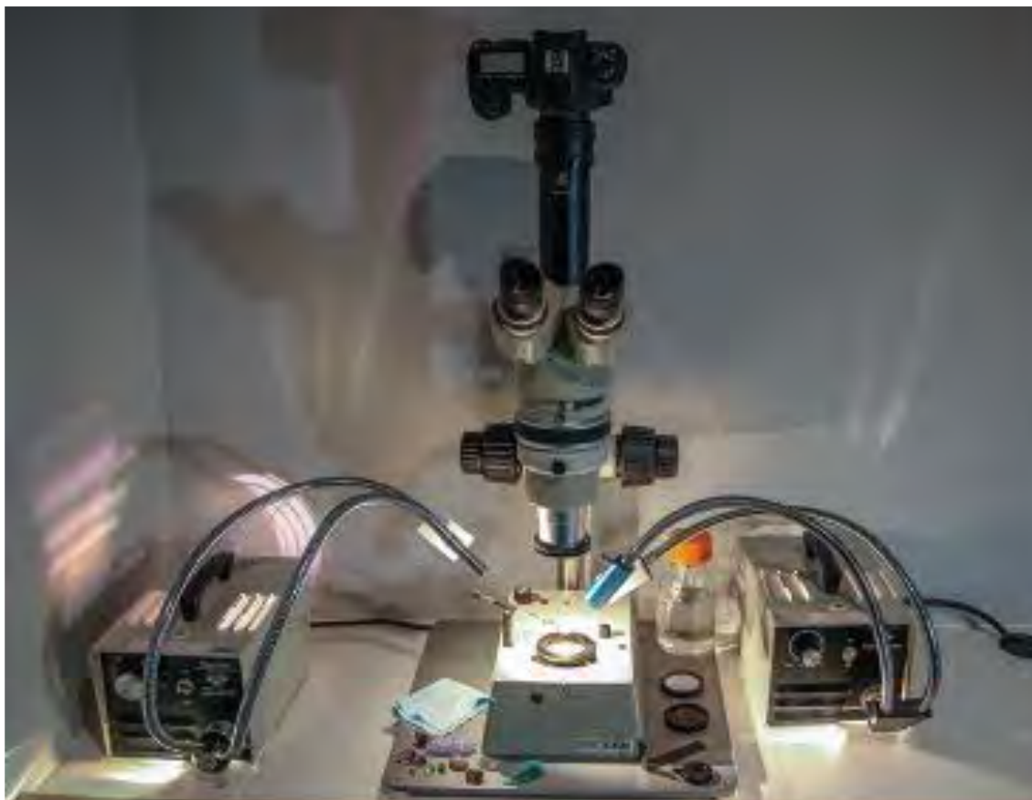
รูปที่ 1.3 กล้องดิจิทัล DSLR ต่อเข้ากับกล้องจุลทรรศน์อัญมณีหือ Nikon SMZ10 โดยใช้ Adarter
