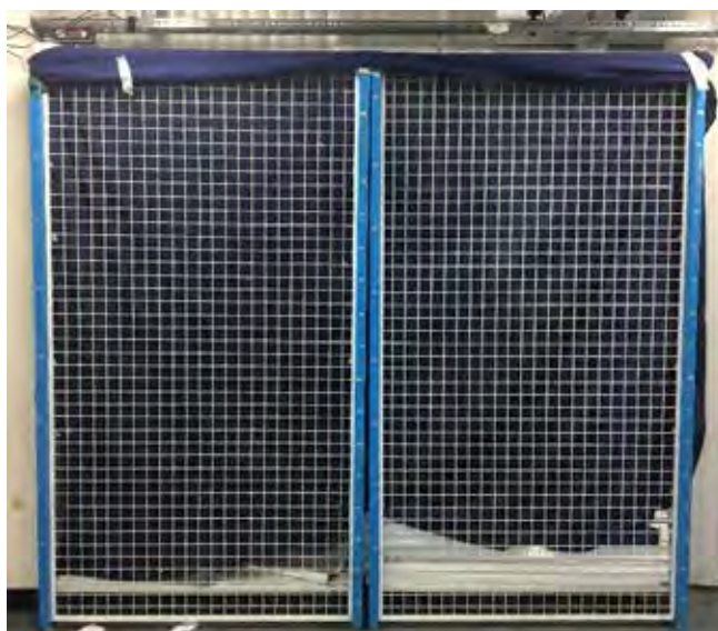
รูปที่ 3.6: ผนังตะแกรงห้องน้ำจำลองสำหรับติดตั้งอุปกรณ์เพื่อวัดตำแหน่งความพอใจ
