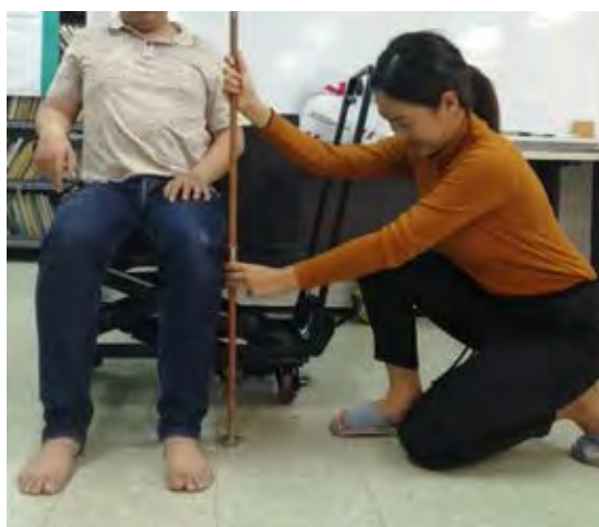
รูปที่ 3.11: วิธีการวัดขนาดสัดส่วนร่างกายโดยเครื่องมือวัดโดยตรง (Anthropometer) (ท่านั่ง)
