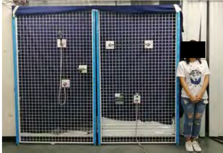
รูปที่ 3.14: แสดงขั้นตอนขณะถ่ายภาพผู้เข้าทดลองเลือกตำแหน่งอุปกรณ์ครบทุกตำแหน่ง
