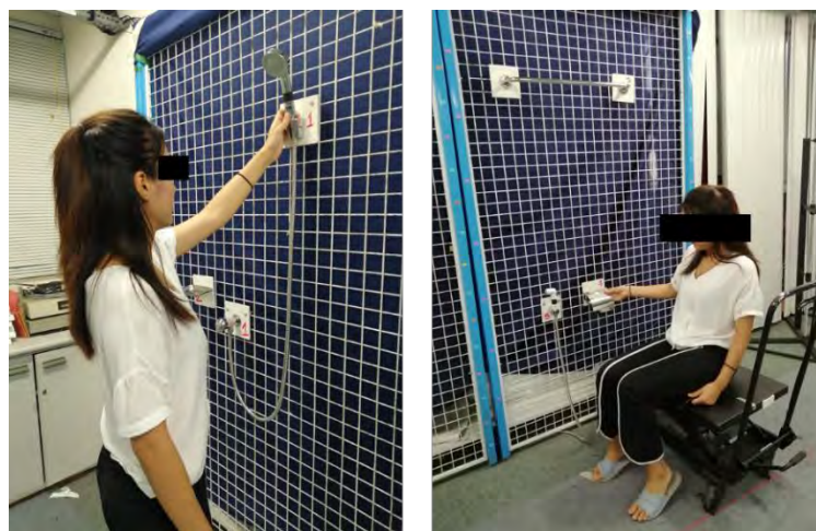
รูปที่ 3.13: วิธีการเลือกระดับความสูงของตำแหน่งการติดตั้งอุปกรณ์ห้องน้ำ
