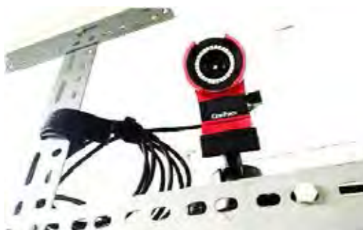
รูปภาพที่ 13 กล้องอินฟราเรด รุ่น Flex 13
