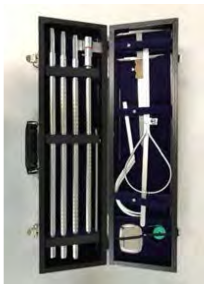
รูปภาพที่ 19 แสดงเครื่องมือวัด Anthropometer Martin Type
