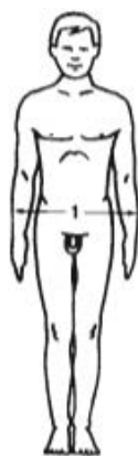
รูปภาพที่ 11 ความกว้างมากที่สุดสำหรับกำหนดความกว้างขั้นต่ำของทางเดิน(Pheasant, 1986)
