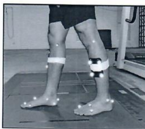
รูปแสดงการติด Retro-reflective marker ที่เท้า ข้อเท้าและเข่า
