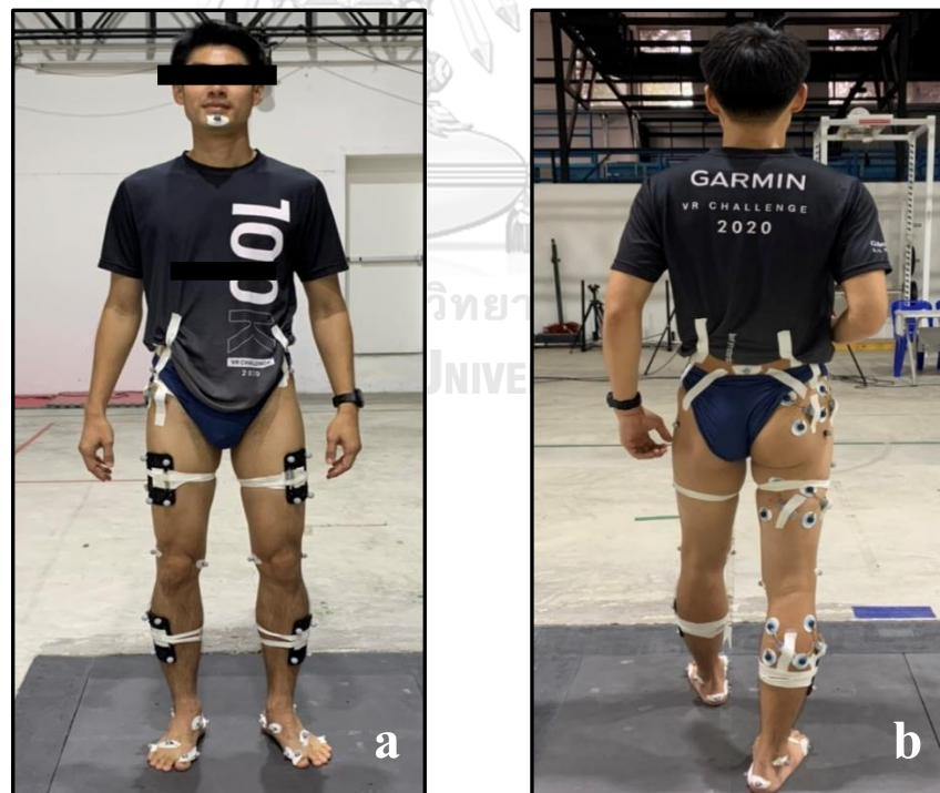
รูปที่ 16 แสดงการติด Surface EMG electrodes และ Retro-reflective markers ที่สะโพกและรยางค์ล่างของร่างกาย (a) มองจากทางด้านหน้าและ (b) ด้านหลัง
