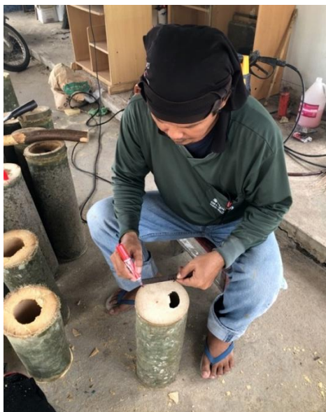
ภาพที่ 89 ช่างเกรียงศักดิ์กำลังสร้างสัญลักษณ์เพื่อเตรียมผ่าไม้ไฟ
