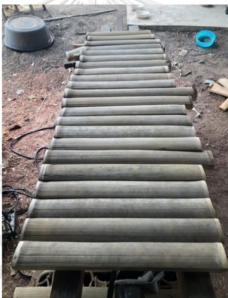
ภาพที่ 112 ลูกระนาดที่ปรับข้างเรียบร้อยแล้ว
