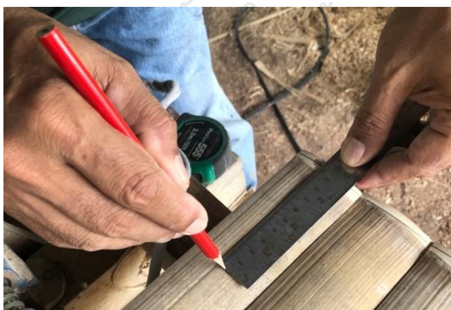
ภาพที่ 118 ช่างเกรียงศักดิ์กำลังวัดระยะสำหรับเตรียมเจาะรู
