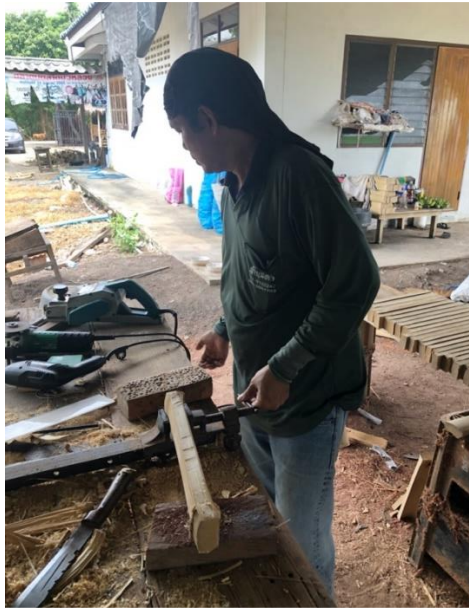
ภาพที่ 110 ช่างเกรียงศักดิ์กำลังวางลูกระนาดบนปากกาจับไม้
