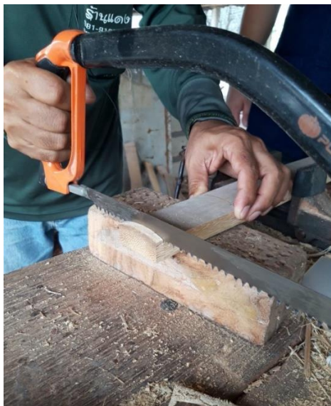
ภาพที่ 123 ช่างเกรียงศักดิ์กำลังใช้เลื่อยตัดไม้ตัดบริเวณหัวท้ายของลูกระนาด
