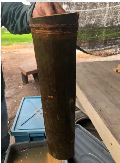
ภาพที่ 98 ไม้ไผ่ที่ผ่านการแช่น้ำเป็นเวลา 4 เดือน
