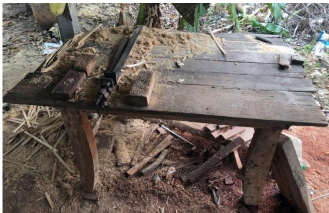
ภาพที่ 52 โต๊ะไสไม้ ที่มา: วรรัตน์ พงษ์เกลี้ยง บันทึกภาพเมื่อวันที่ 9 ตุลาคม 2563
