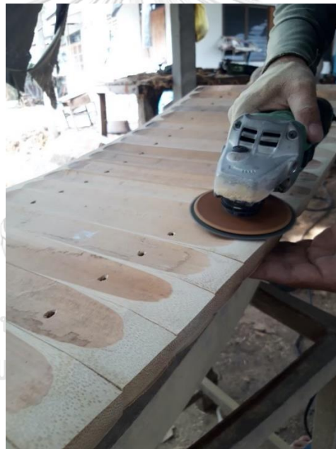
ภาพที่ 133 ช่างเกรียงศักดิ์กำลังใช้เครื่องเจียรไฟฟ้าเจียรบริเวณด้านใต้ฝากระดาน
