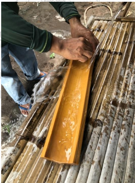
ภาพที่ 100 ช่างเกรียงศักดิ์กำลังทำความสะอาดผิวไม้ไผ่ด้านใน
