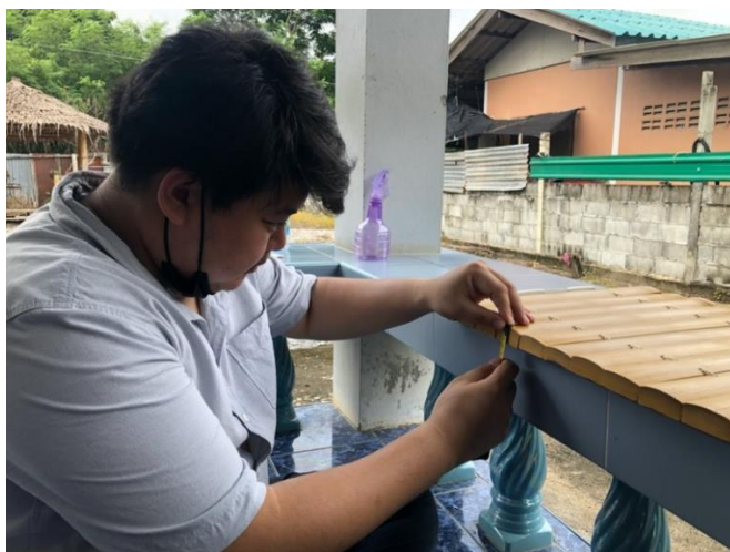
ภาพที่ 155 ผู้วิจัยกำลังวัดความหนาของลูกระนาดเอก ที่มา: วรุตต์ พงษ์เกลี้ยง บันทึกภาพเมื่อวันที่ 29 ตุลาคม 2563
