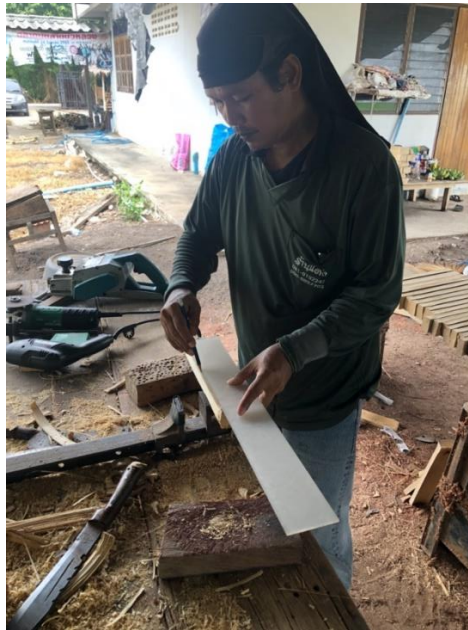
ภาพที่ 108 ช่างเกรียงศักดิ์กำลังใช้แผ่นอะคริลิกทาบบนลูกระนาดและขีดเส้น
