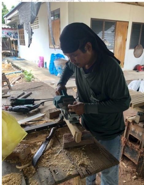
ภาพที่ 111 ช่างเกรียงศักดิ์กำลังใช้กบไสไฟฟ้าไสเพื่อปรับข้าง
