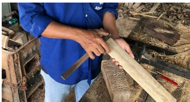
ภาพที่ 107 ช่างเกรียงศักดิ์กำลังใช้ข้อมวัดความกว้างของลูกกระนาด
