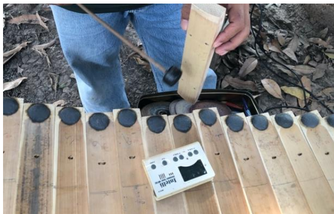
ภาพที่ 144 ช่างเกรียงศักดิ์กำลังวัดระดับเสียงเพื่อเตรียมปาดทองและเทียบเสียง
