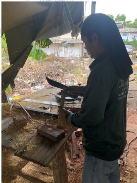
ภาพที่ 109 ช่างเกรียงศักดิ์กำลังใช้มีดอีเหล็บผ่าลูกระนาดตามเส้นที่ขีดไว้
