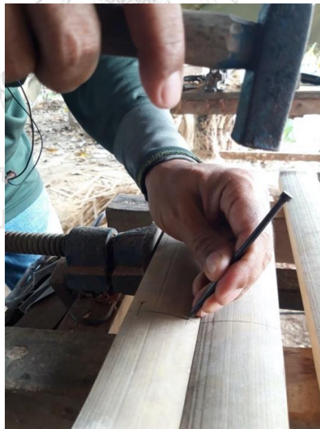
ภาพที่ 121 ช่างเกรียงศักดิ์กำลังตอกตะปูเพื่อสร้างสัญลักษณ์สำหรับเจาะรู
