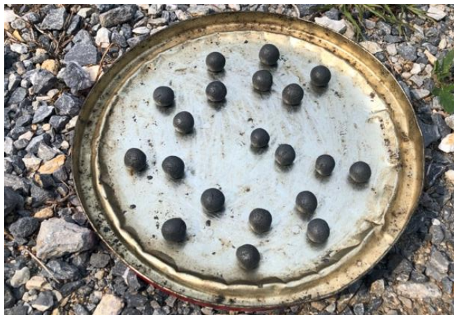
ภาพที่ 140 ตะกั่วที่ถูกปั้นเป็นก้อนกลมและนำไปตากแดด
