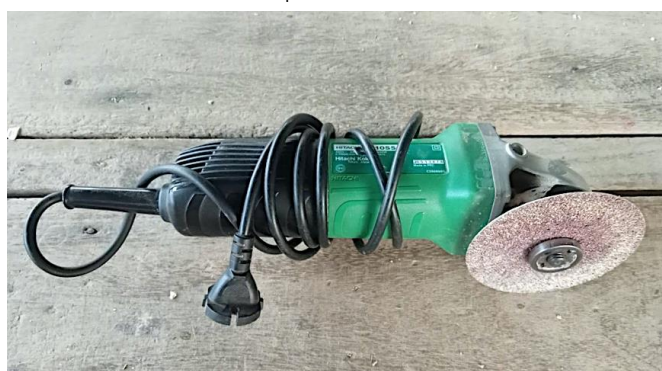
ภาพที่ 68 เครื่องเจียรไฟฟ้าและใบเจียรเบอร์ 24
