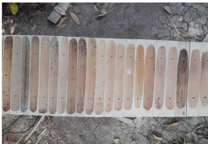
ภาพที่ 134 ฝืนขนาดที่ถูกเจียรบริเวณด้านใต้แล้ว
