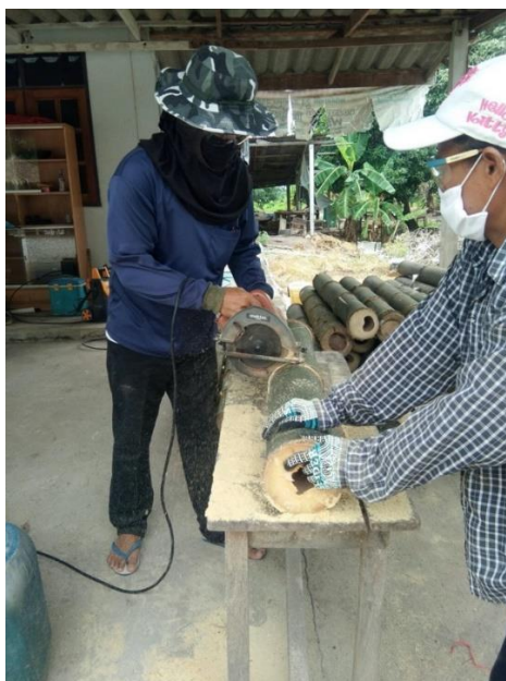
ภาพที่ 86 ช่างเกรียงศักดิ์กำลังแบ่งปล้องไม้ไผ่โดยมีภรรยาเป็นผู้ช่วย
