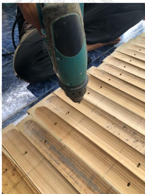
ภาพที่ 141 ภรรยาของช่างเกรียงศักดิ์กำลังใช้เครื่องเป่าลมร้อนเป่าบริเวณรูร้อยเชือก
