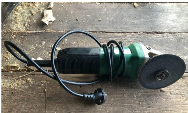
ภาพที่ 70 เครื่องเจียรไฟฟ้าและใบเจียรเบอร์ 100
