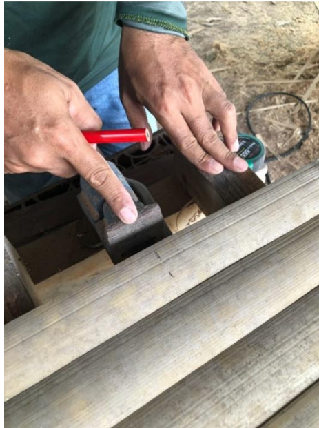
ภาพที่ 114 ตำแหน่งจุดศูนย์กึ่งกลางระหว่างตุ้กระนาดกับแท่นรองฝืนระนาด ที่มา: วรุตต์ พงษ์เกลี้ยง บันทึกภาพเมื่อวันที่ 17 ตุลาคม 2563
