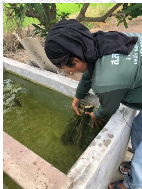
ภาพที่ 94 ช่างเกรียงศักดิ์กำลังนำไม้ไผ่แช่น้ำในบ่อน้ำ ที่มา: วรุตต์ พงษ์เกลี้ยง บันทึกภาพเมื่อวันที่ 9 ตุลาคม 2563
