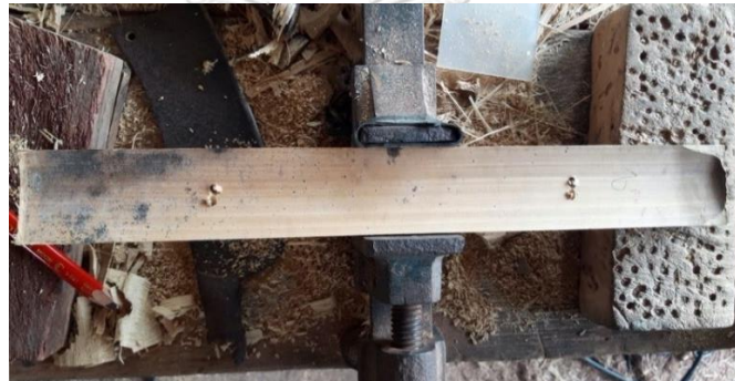
ภาพที่ 127 ด้านหลังลูกระนาดที่เจาะรูร้อยเชือกแล้ว ที่มา: วรุตต์ พงษ์เกลี้ยง บันทึกภาพเมื่อวันที่ 17 ตุลาคม 2563
