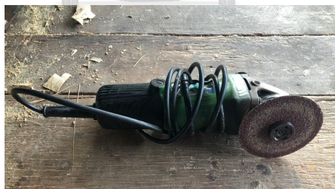
ภาพที่ 69 เครื่องเจียรไฟฟ้าและใบเจียรเบอร์ 36
