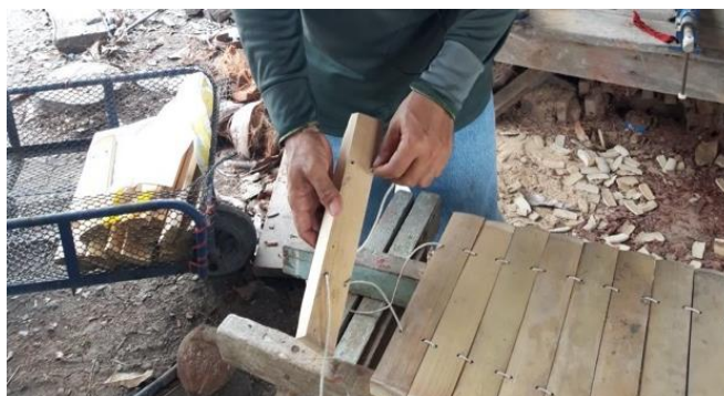
ภาพที่ 129 ช่างเกรียงศักดิ์กำลังร้อยเชือก
