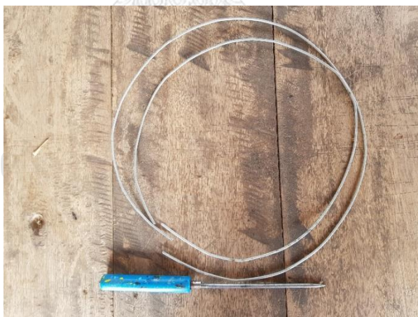
ภาพที่ 58 การนำลวดมาดัดเป็นวงกลมขนาดพอดีกับหุ่นกลอง ที่มาภาพ: สุวิชา พระยาชัย
