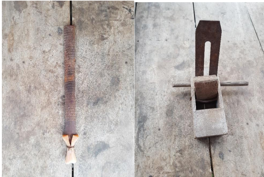
ภาพที่ 32 ตะไบ (ด้านซ้าย) กบมือ (ด้านขวา) ที่มาภาพ: สุวิชา พระยาชัย
