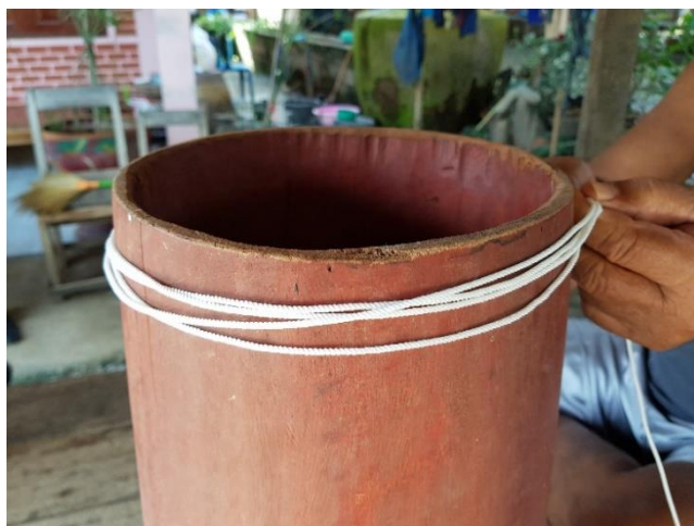
ภาพที่ 59 การนำเชือกฝ้ายรมมาวัดขนาดกับกลองจำนวน 4 รอบ
