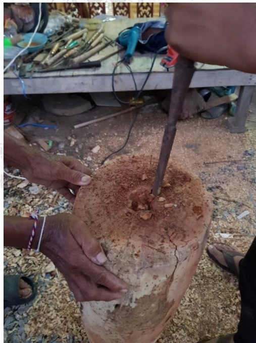
ภาพที่ 43 การใช้สิ่วชุดคว้านเนื้อไม้ออก จนทะลุเป็นโพรง ที่มาภาพ: สุวิชา พระยาชัย
