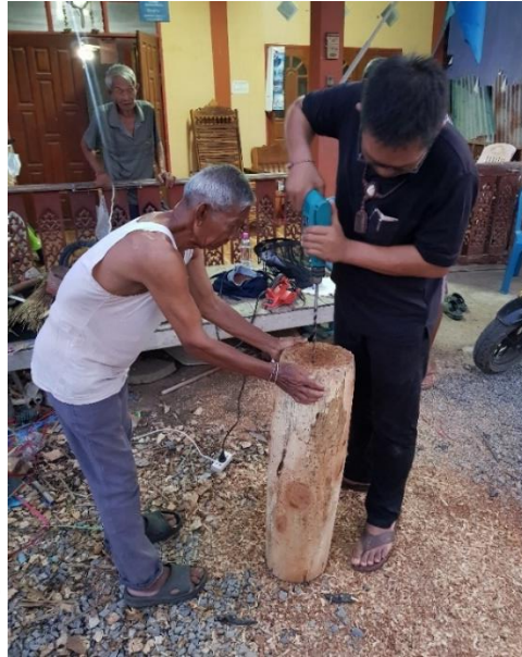
ภาพที่ 42 การใช้สว่านไฟฟ้าในการเจาะรูสำหรับชุด ที่มาภาพ: สุวิชา พระยาชัย
