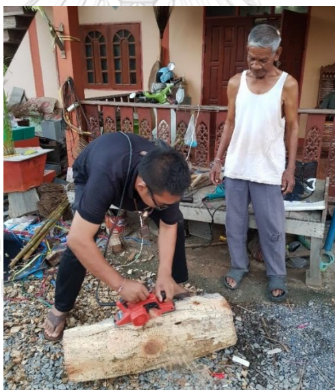
ภาพที่ 41 การใช้กบไฟฟ้าในการตกแต่งให้เป็นรูปทรงของหุ่นกลอง ที่มาภาพ: สุวิชา พระยาชัย
