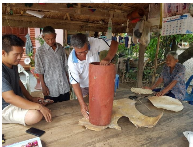
ภาพที่ 48 อารีย์ ไกรบุตร กำหนดขนาดของหน้ากลองด้านในโดยวาดเส้นให้เท่ากับหน้ากลอง ที่มาภาพ: สุวิชา พระยาชัย
