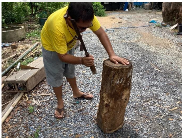
ภาพที่ 35 การแต่งรูปทรงของไม้ให้เป็นรูปทรงกระบอก
