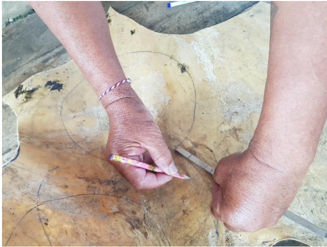
ภาพที่ 49 การวัดระยะขอบกลองออกไปจากหน้ากลองด้านใน ประมาณ 2 นิ้ว ที่มาภาพ: สุวิชา พระยาชัย
