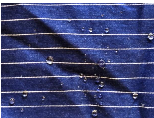
ภาพที่ 24 : การทดลองเคลือบเส้นใยด้วยนวัตกรรมนาโน เพื่อคุณสมบัติสะท้อนน้ำ บนเส้นใยโพลีเอสเตอร์ผสมฝ้าย
