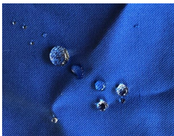
ภาพที่ 23 : การทดลองเคลือบเส้นใยด้วยนวัตกรรมนาโน เพื่อคุณสมบัติสะท้อนน้ำ บนเส้นใยขนสัตว์
