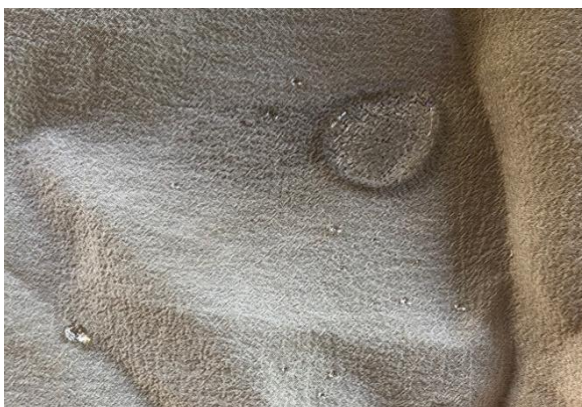
ภาพที่ 25 : การทดลองเคลือบเส้นใยด้วยนวัตกรรมนาโน เพื่อคุณสมบัติสะท้อนน้ำ บนเส้นใยโพลีเอสเตอร์ผสมไหม
