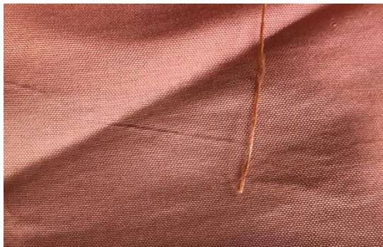
ภาพที่ 15 : การทดลองเคลือบเส้นใยด้วยนาโน เพื่อคุณสมบัติยับยั้งแบคทีเรีย บนเส้นใยไหม
