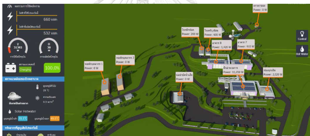
รูปที่ 3-1 ระบบตรวจวัดและบริหารจัดการพลังงานภายในอาคารของโรงพยาบาล
