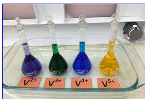
รูปที่ 2-16 สารละลายอิเล็กโทรไลต์และช่องสำหรับเติมสารละลายอิเล็กโทรไลต์แบตเตอรี่ VRF
