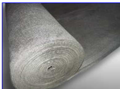
รูปที่ 2-15 แผ่น carbon felt สำหรับใช้กับแบตเตอรี่ VRF [6]
