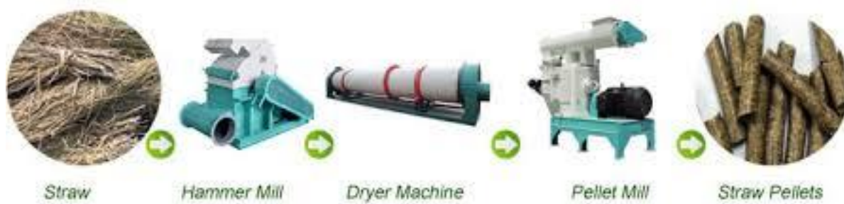
จุฬาลงกรณ์มหาวิทยาลัย ภาพที่ 4.2 กระบวนการผลิตเชื้อเพลิงชีวมวลอัดเม็ด ที่มา : สถาบันพลาสติก , 2559
