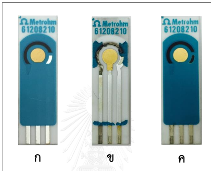
ภาพที่ 4.2 ขั้วไฟฟ้าทองชนิดพิมพ์สกรีน (ก) ก่อนการแช่ในตัวทำละลาย, (ข) หลังผ่านการแช่ด้วยตัวทำละลายผสมระหว่างเมทานอลและโทลูอิน (1:1) และ (ค) หลังผ่านการแช่ด้วยตัวทำละลายเมทานอลและกรดแอสติก (98:2)
