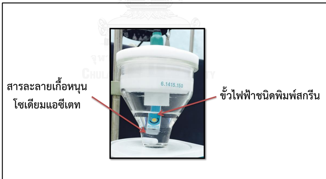
ภาพที่ 3.2 ส่วนประกอบของเซลล์ไฟฟ้าเคมี เมื่อใช้ขั้วไฟฟ้าชนิดพิมพ์สกรีน (Screen-printed electrode)
