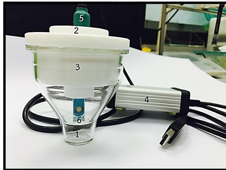
ภาพที่ 3.3 ส่วนประกอบต่างๆ ของเซลล์ไฟฟ้าเคมี เมื่อใช้ขั้วไฟฟ้าชนิดพิมพ์สกรีน (ก) ภาพแสดงส่วนต่างๆ ของอุปกรณ์, (ข) ภาพเซลล์ไฟฟ้าเคมีเมื่อประกอบชิ้นงานพร้อมใช้
