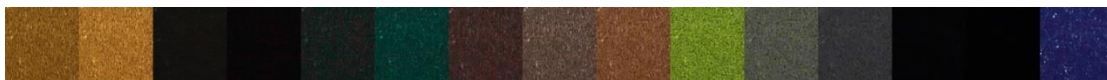
ภาพที่ 4.23 ภาพถ่ายสารสี Raw Sienna brownish ภายใต้แอลอีดีช่องสัญญาณที่ 1-15 ผ่านฟิลเตอร์ที่ให้แสงขาวผ่าน
