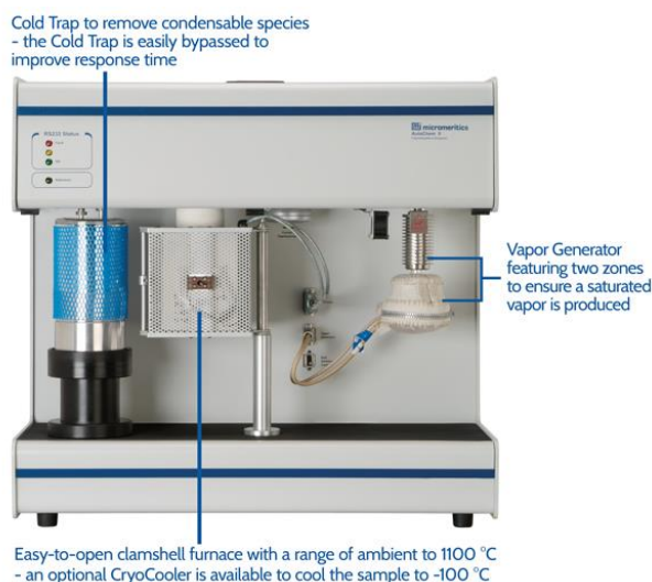
รูปที่ 3.6 เครื่องดูดซับทางเคมี ยี่ห้อ Micromeritics AutoChem II 2920 [30]
