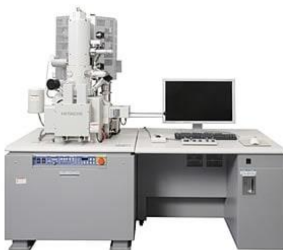
รูปที่ 3.7 กล้องจุลทรรศน์อิเล็กตรอนแบบส่องกราดที่มีสมรรถนะสูงชนิดฟิลด์อิมิสชัน ยี่ห้อ HITACHI SU-8010 [31]
