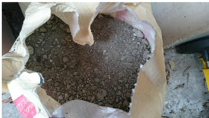
รูปที่ ก-4 กากคอนกรีตจากโรงผลิตคอนกรีต
