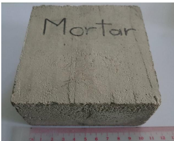
รูปที่ ก-9 ตัวอย่างมอร์ตาร์ขนาด 10 x 10 x 5 ลูกบาศก์เซนติเมตร สำหรับทดสอบสภาพการนำความร้อน (thermal conductivity)
