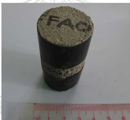
รูปที่ ก-10 ตัวอย่างมอร์ตาร์ทรงกระบอกความหนา 5 เซนติเมตร เส้นผ่านศูนย์กลาง 3 เซนติเมตร สำหรับทดสอบสมบัติเชิงเสียง
