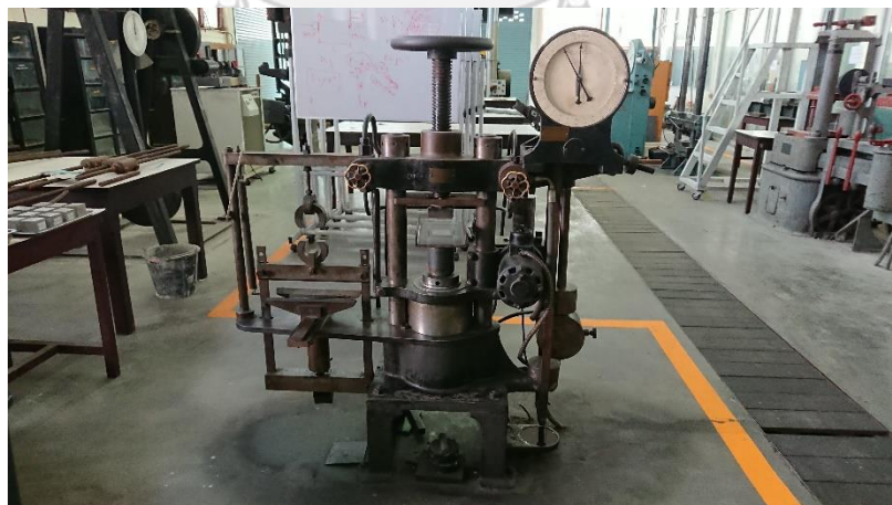
รูปที่ ก-8 เครื่องทดสอบแรงอัดคอนกรีต (compression machine) Amsler 30 ton
