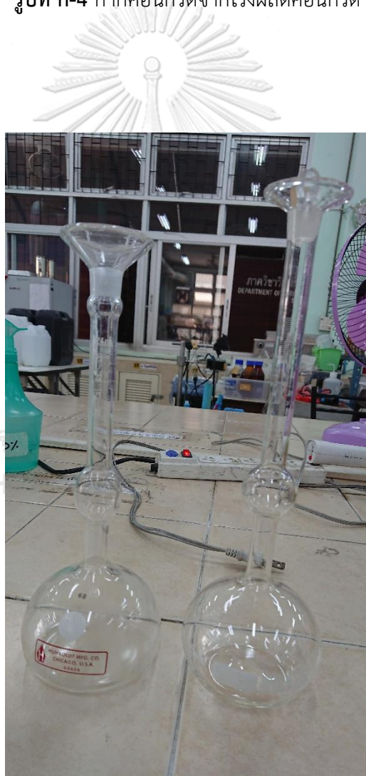
รูปที่ ก-5 ขวดแก้วใสหาความถ่วงจำเพาะ (Le Chatelier Flask) ตามมาตรฐาน ASTM C188
