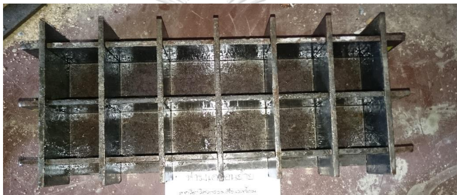
รูปที่ ก-7 แบบหลอมออร์ตาร์ขนาด 5 x 5 x 5 ลูกบาศก์เซนติเมตร
