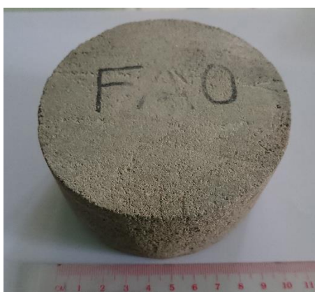
รูปที่ ก-11 ตัวอย่างมอร์ตาร์ทรงกระบอกความหนา 5 เซนติเมตร เส้นผ่านศูนย์กลาง 10 เซนติเมตร สำหรับทดสอบสมบัติเชิงเสียง
