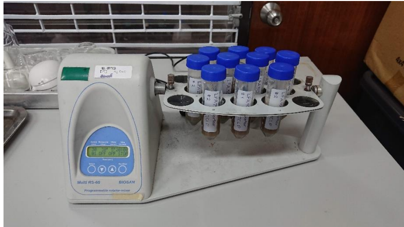
รูปที่ ก-6 เครื่องเขย่าผสมสารชนิดหมุน (rotator mixer) ของบริษัท Biosan รุ่น Multi RS-60
