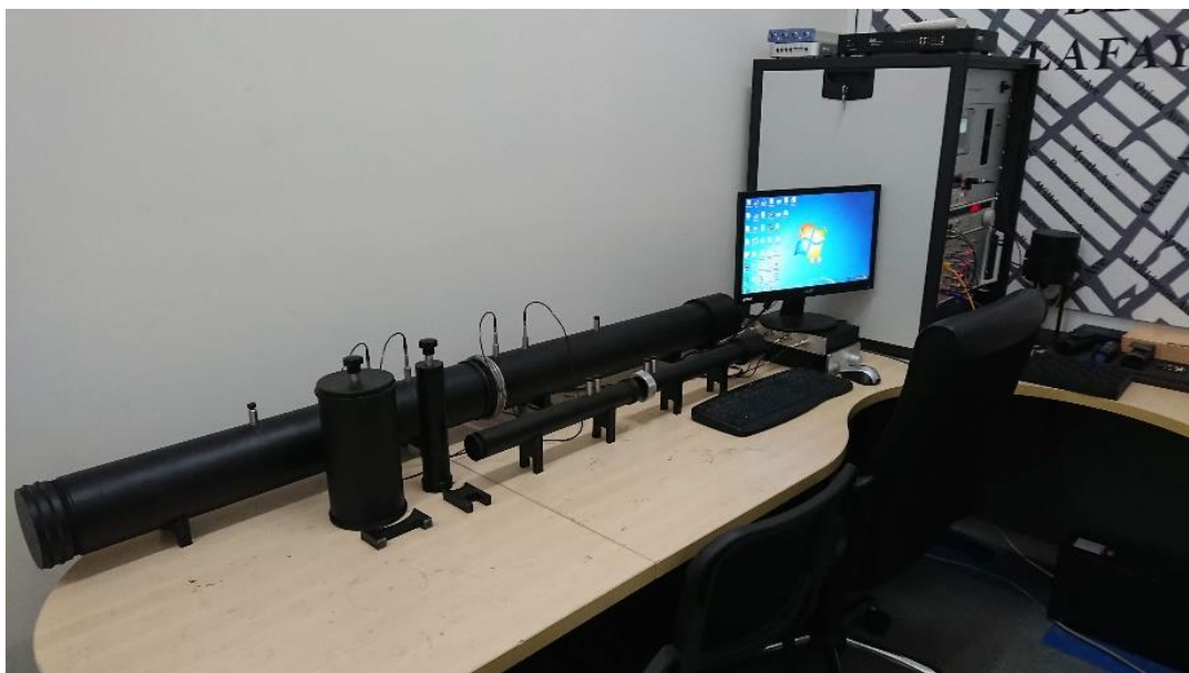
รูปที่ ก-12 ท่อนำคลื่นเสียง (impedance tube) และชุดทดสอบสมบัติเชิงเสียงของบริษัท
