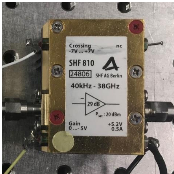
รูปที่ 2.24 ตัวขยายสัญญาณไฟฟ้าของบริษัท SHF รุ่น SHF810
