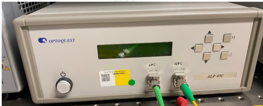
รูปที่ 2.18 ตัวควบคุมโพลาไรเซชันอัตโนมัติของบริษัท Optoquest รุ่น ALP05C
