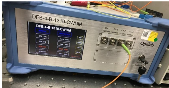
รูปที่ 2.5 เลเซอร์ดีเอฟบีของบริษัท Optilab รุ่น DFB-4-B-1310-CWDM
