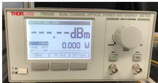
รูปที่ 2.29 มิเตอร์วัดกำลังแสงของบริษัท Thorlabs รุ่น PM320E
