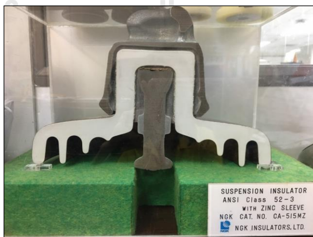
รูปที่ จ.1 (ก) เรขาคณิตของลูกถ้วย ANSI 52-3 (ข) ภาคตัดขวางของลูกถ้วยจริง
