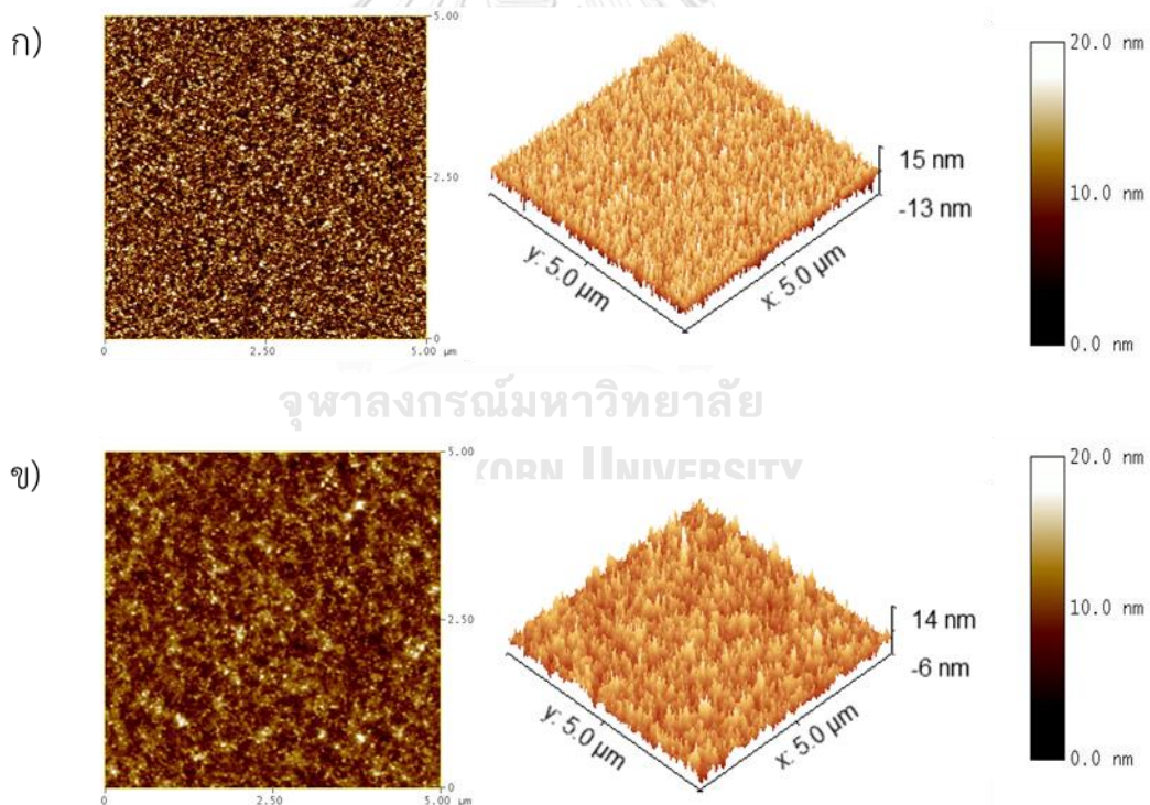
รูปที่ 4.8 ความหยาบผิวของชั้นเคลือบ TiN ที่เคลือบด้วย ก) เทคนิค DCMS และ ข) เทคนิค HiPIMS บนแผ่นซิลิกอน
