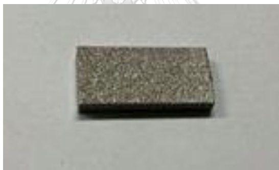
รูปที่ 3. 1 แสดงชิ้นงานไทเทเนียมผสม Ti-6Al-4V (Ti64) เกรด 5 ที่ขึ้นรูปด้วยการพิมพ์สามมิติ
