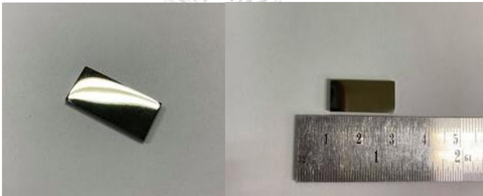
รูปที่ 4.2 ชิ้นงาน Ti-6Al-4V ที่ขึ้นรูปด้วยการพิมพ์สามมิติหลังจากเตรียมผิวเรียบร้อยแล้ว
