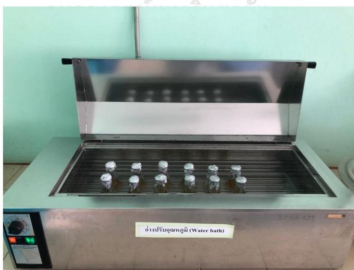
ภาพที่ 3.10 เครื่อง Water bath สำหรับกระบวนการ Heat shock
