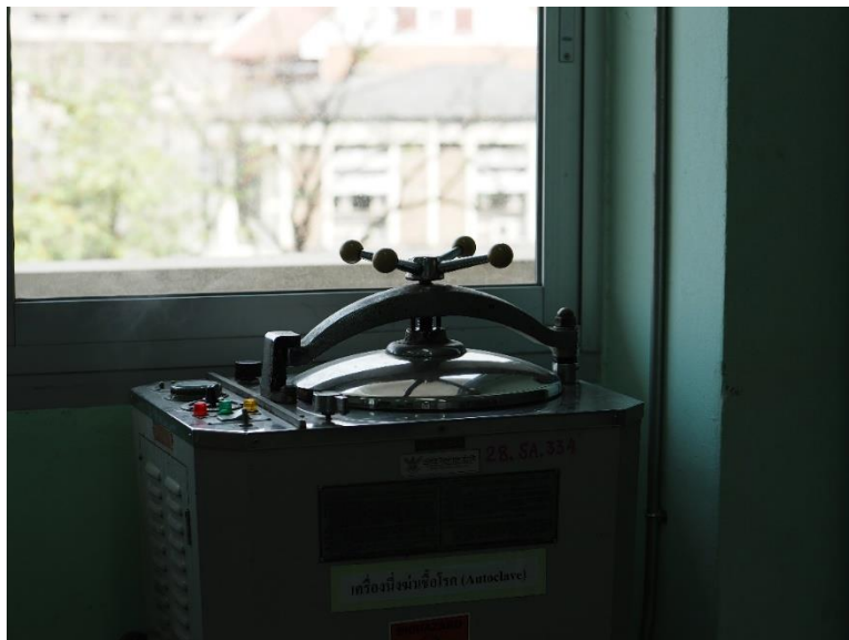
ภาพที่ 3.3 เครื่อง Autoclave สำหรับนึ่งฆ่าเชื้อโรค
