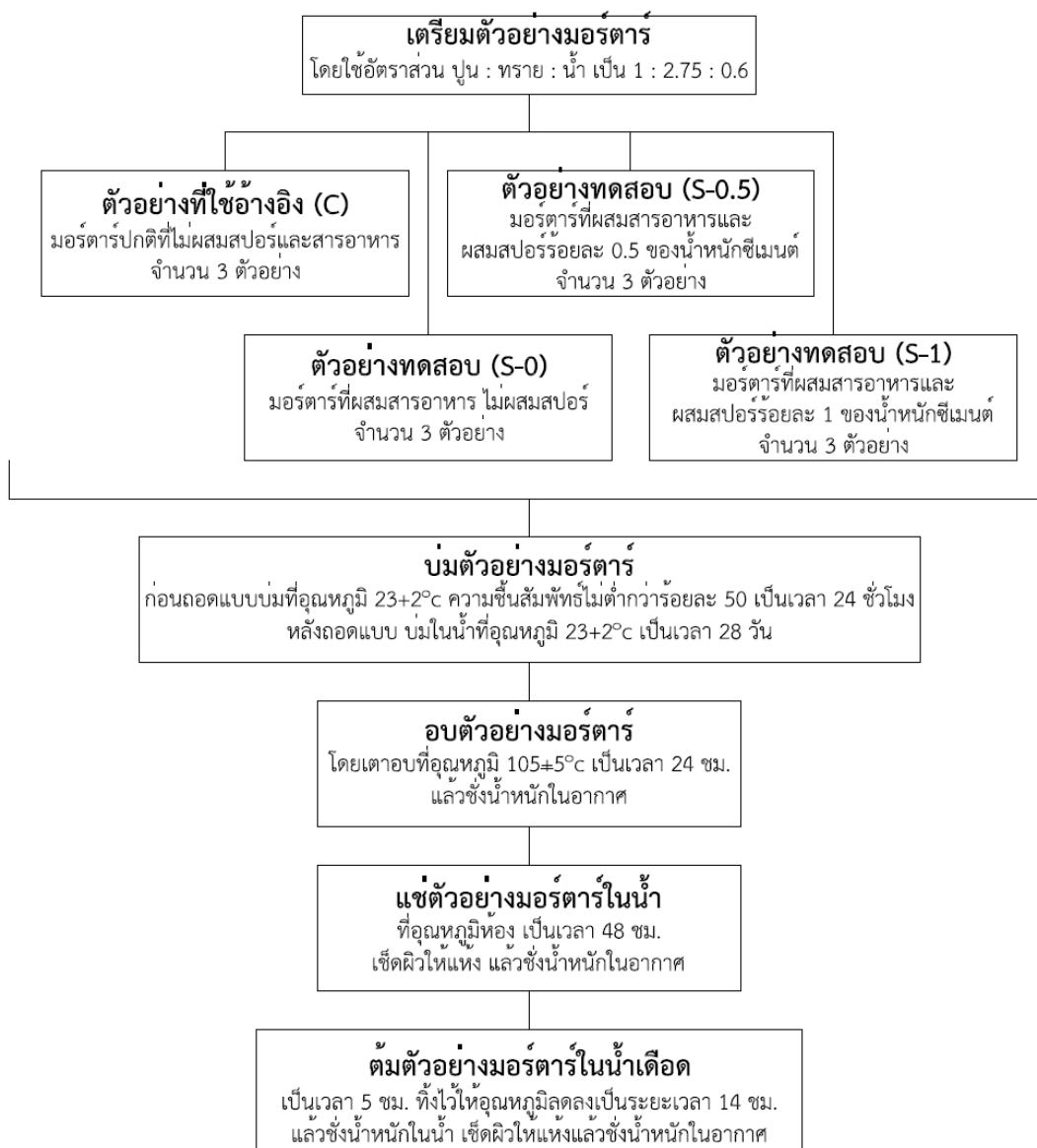
ภาพที่ 3.22 ขั้นตอนสำหรับการทดสอบความพรุนและการดูดซึมน้ำของมอร์ตาร์
