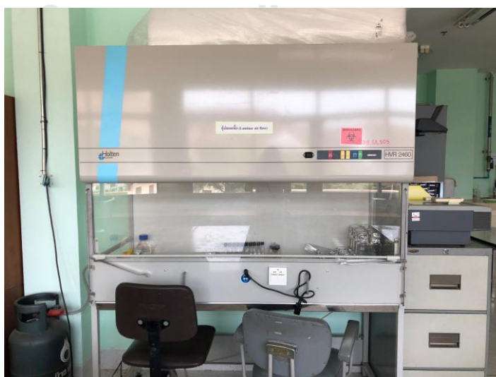
ภาพที่ 3.6 ตู้ปลอดเชื้อสำหรับกระบวนการขยายพันธุ์เชื้อ
