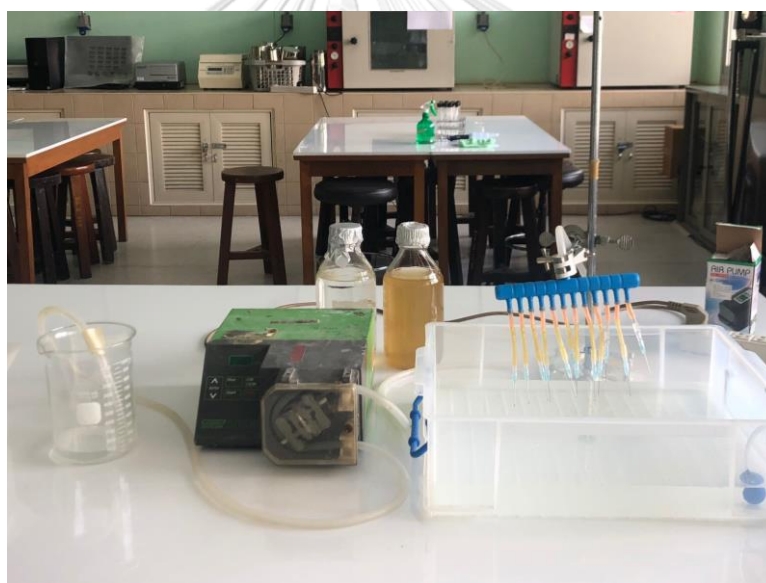
ภาพที่ 3.14 การห่อหุ้มสพอร์ด้วยเทคนิค Extrusion
