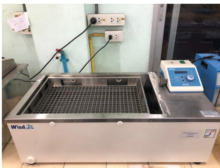
ภาพที่ 3.9 เครื่อง Water bath shaker สำหรับกระบวนการขยายพันธุ์เชื้อ
