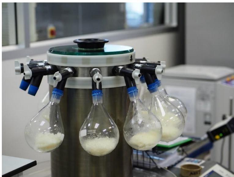
ภาพที่ 3.15 การห่อหุ้มสปอร์ด้วยเทคนิค Freeze Drying
