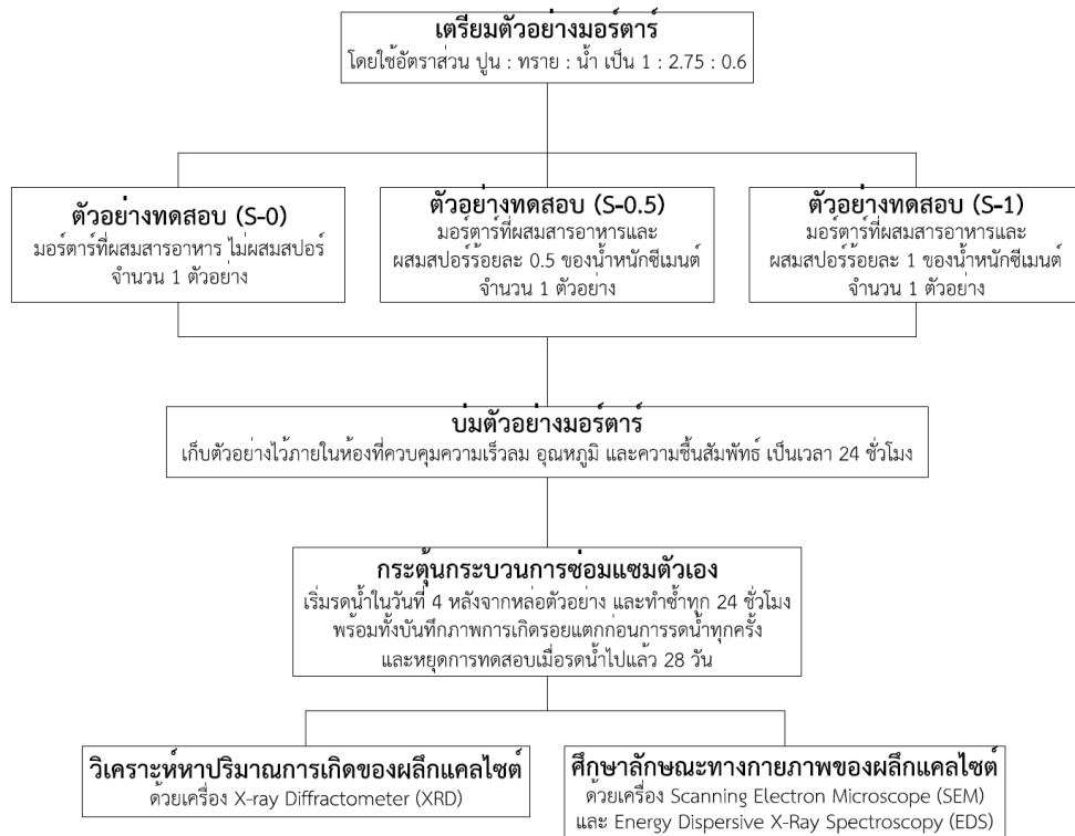
ภาพที่ 3.24 ขั้นตอนการทดสอบประสิทธิภาพในการซ่อมแซมรอยแตกของ mortars
