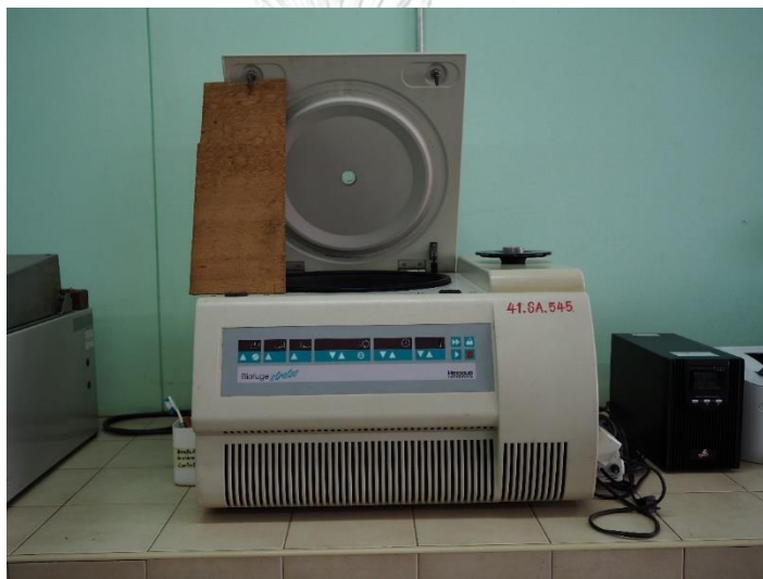
ภาพที่ 3.11 เครื่อง Centrifuge สำหรับคัดแยกสปอร์
