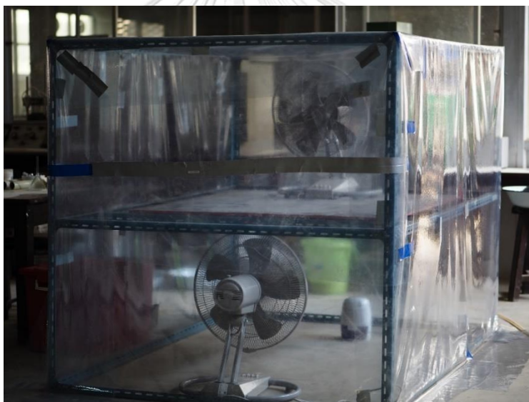
ภาพที่ 3.21 ห้องที่ใช้ในการเก็บตัวอย่างทดสอบประสิทธิภาพในการซ่อมแซมรอยแตก
