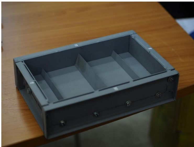
ภาพที่ 3.20 แบบหล่อที่ใช้ในการทดสอบประสิทธิภาพในการซ่อมแซมรอยแตก
