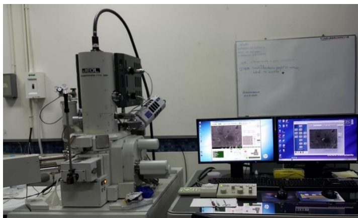
รูปที่ 3.5 กล้องจุลทรรศน์อิเล็กตรอนแบบส่องกราดชนิดฟิลด์อิมิชชัน ยี่ห้อ JEOL รุ่น JSM-7610F
