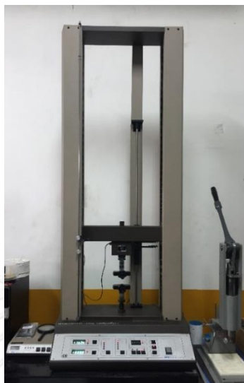
รูปที่ 3.4 เครื่องทดสอบแรงดึง ยี่ห้อ HOUNSFIELD รุ่น H10KM
