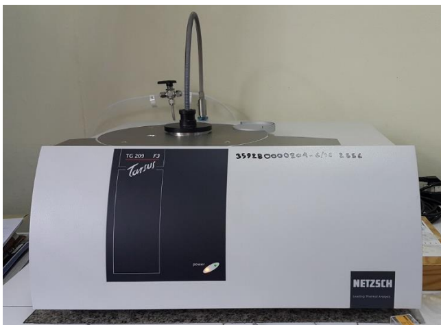
รูปที่ 3.7 เครื่องวิเคราะห์น้ำหนักภายใต้ความร้อน (ทีจีเอ) ยี่ห้อ NETZSCH รุ่น TG 209 F3 Tarsus
