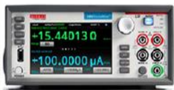
รูปที่ 3.6 เครื่องวัดค่าความต้านทานด้วยวิธีเข็มวัด 4 จุด ยี่ห้อ KEITHLEY รุ่น 2450
